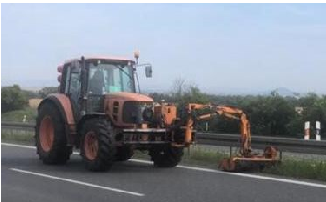
Obr 34: Foto údržbové práce na sil. I/6 - ramenová sekačka rok 2023 (autorka 2023)
