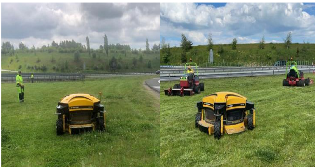
Obr. 33: Foto údržbové práce na dálnici D6 - nová technologie - svahová sekačka Spider rok 2023 (autorka 2023)
