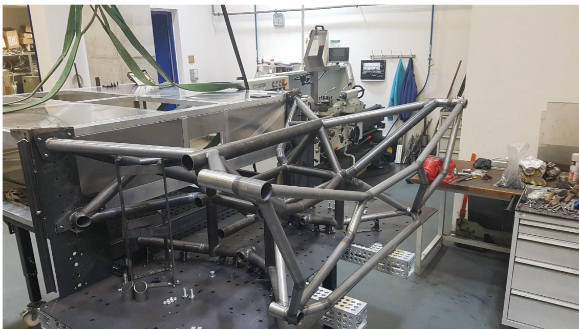
Obrázek 6: Téměř dokončený hlavní rám v přípravku s namontovaným nárazníkem, E-boxem a rámem baterie
