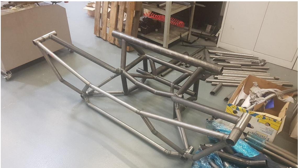
Obrázek 4: Svařená část hlavního rámu s přimontovaným nárazníkem
