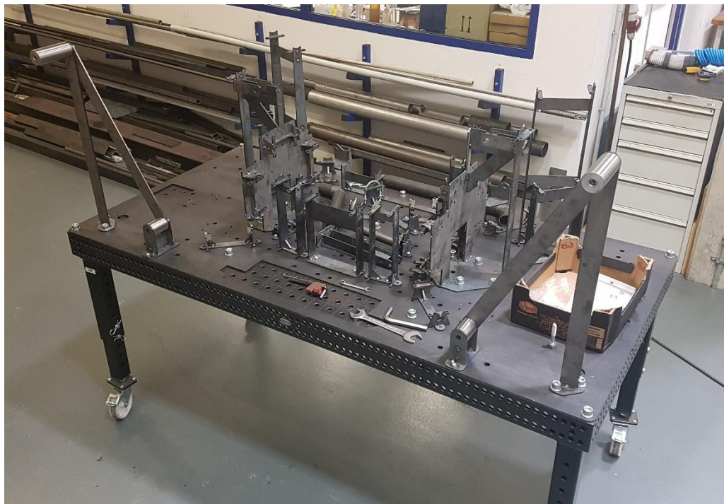
Obrázek 54: Připravený svařovací přípravek hlavního rámu
