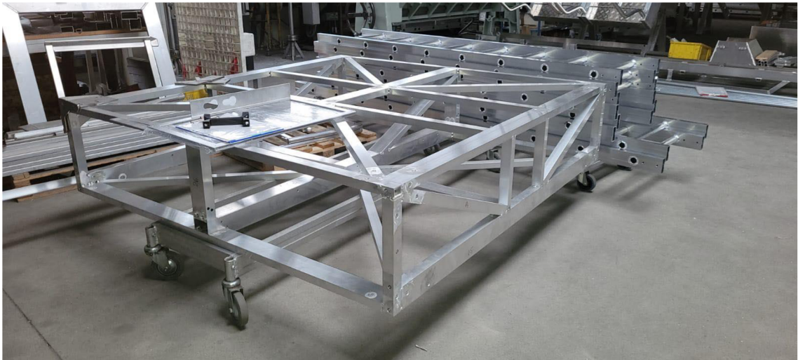
Obrázek 57: Rozpracovaný hliníkový rám E-boxu
