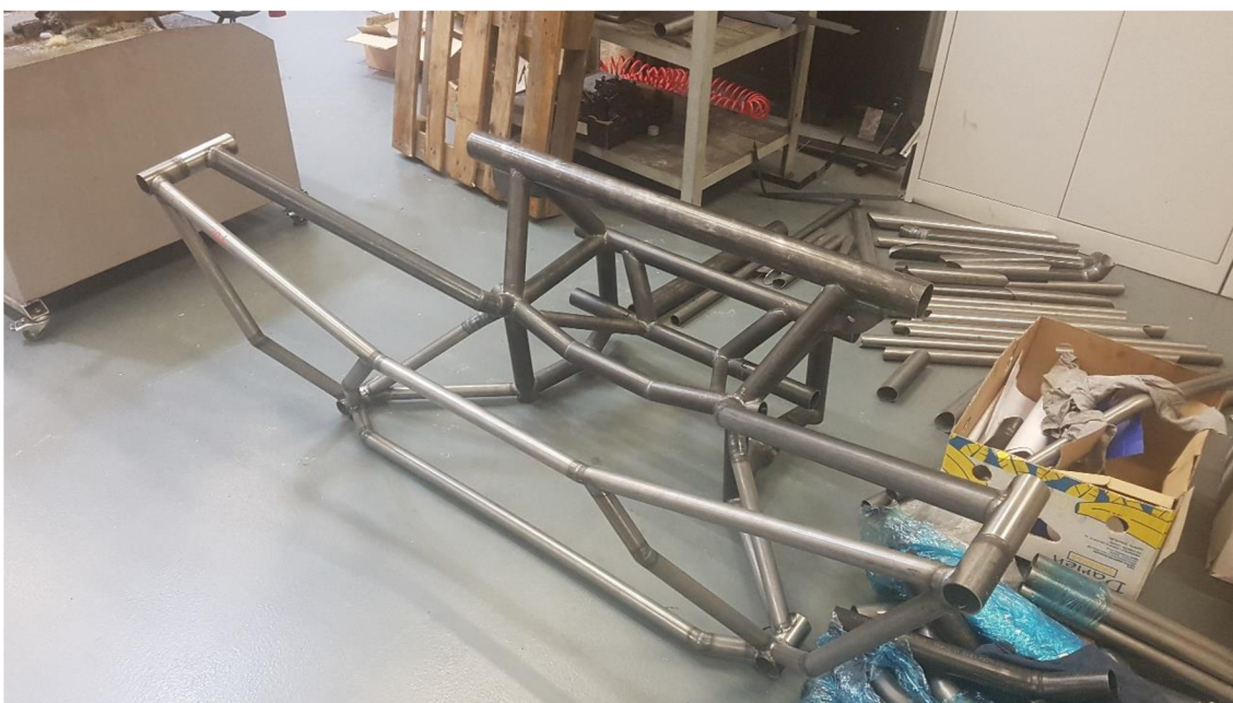
Obrázek 4: Svařená část hlavního rámu s přimontovaným nárazníkem
