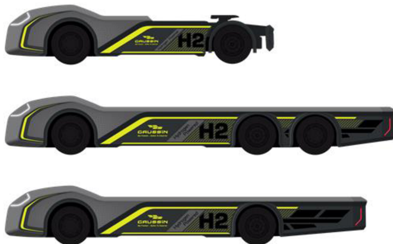
Obrázek 11: Ukázka možných konfigurací modulární plošiny [21]
