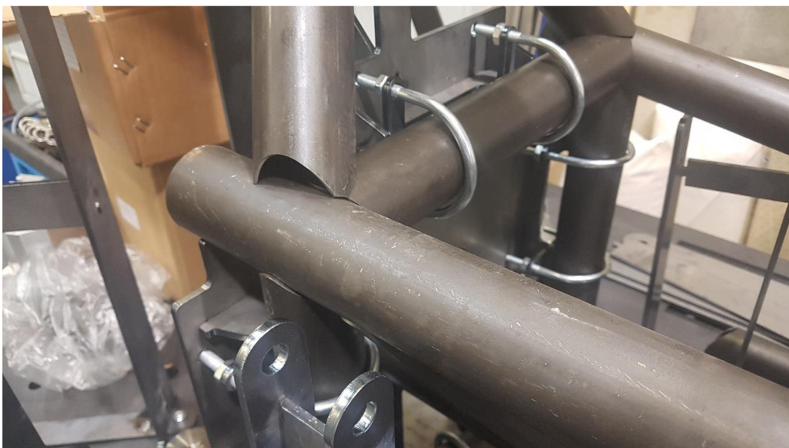
Obrázek 3: Detailní pohled na spoj trubek hlavního rámu
