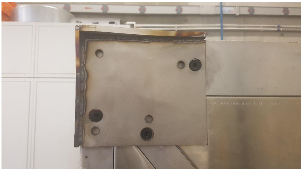
Obrázek 58: Horní pohled na spojovací roh E-boxu a hlavního rámu
