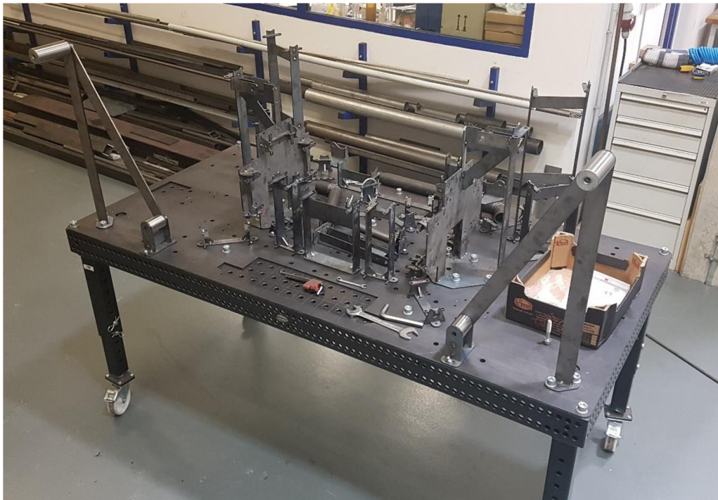
Obrázek 54: Připravený svařovací přípravek hlavního rámu
