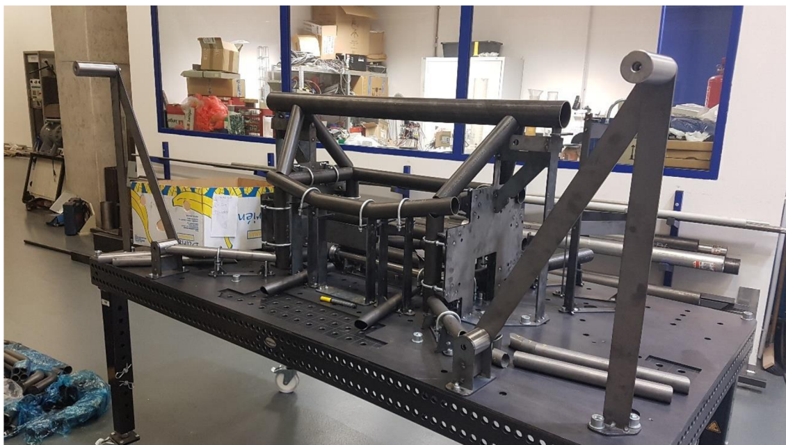
Obrázek 1: Hlavní rám usazený v přípravku
