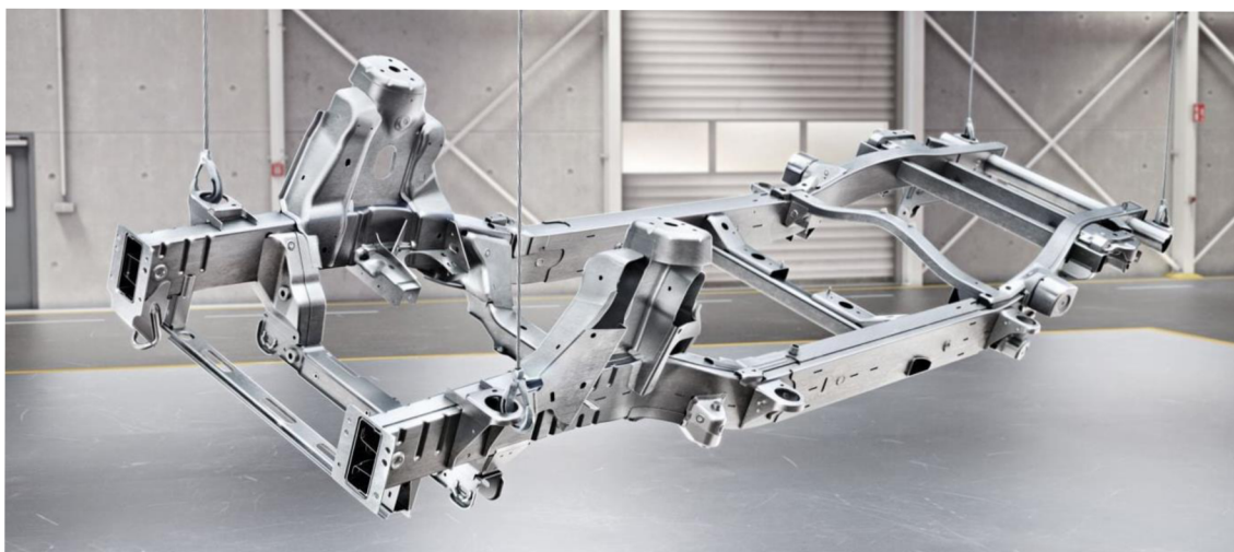
Obrázek 15: Žebřinový rám terénního vozu Mercedes-Benz třídy G [28]
