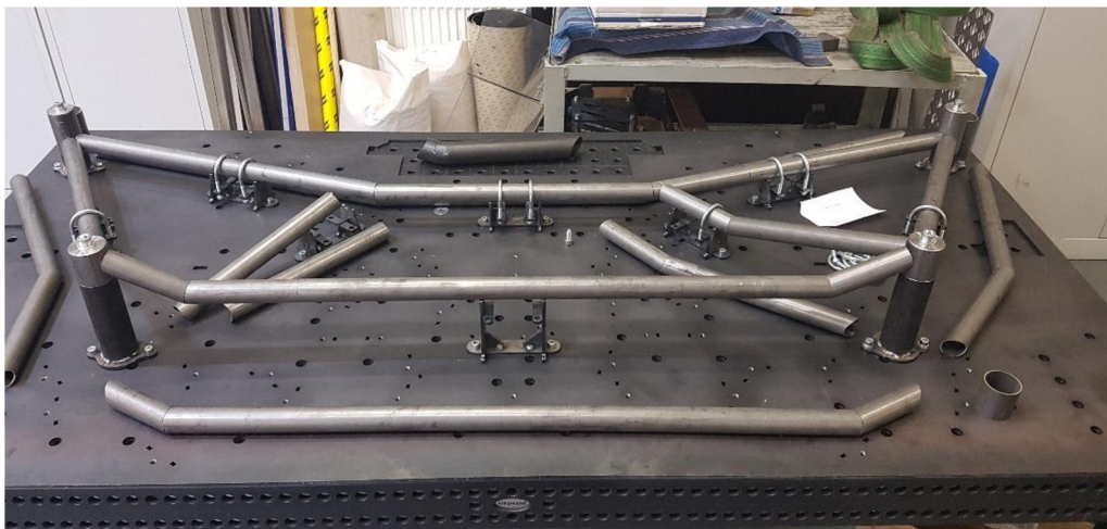
Obrázek 55: Trubky nárazníku připravené ke svařování
