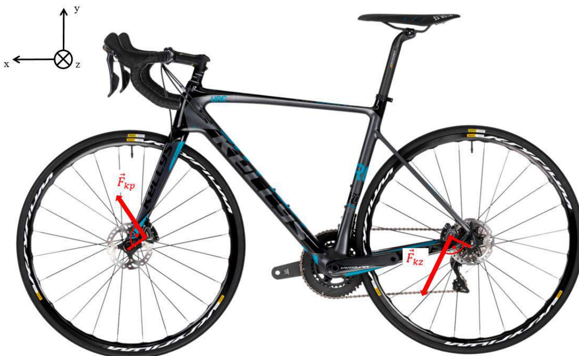
Obrázek 9.7: Síly vzniklé brzděním hydraulickými kotoučovými brzdami [75]
