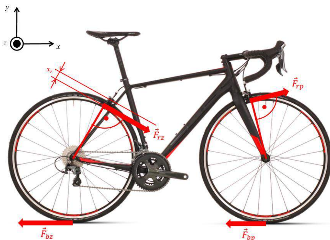
Obrázek 9.5: Síly vzniklé brzděním ráfkovými brzdami [74]
