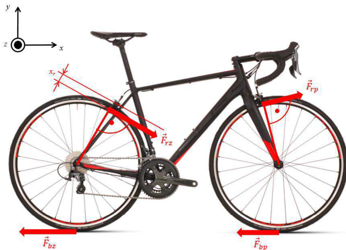
Obrázek 9.5: Síly vzniklé brzděním ráfkovými brzdami [74]
