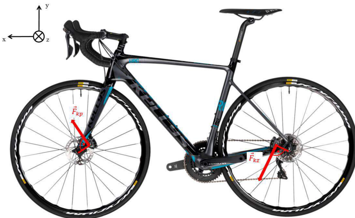
Obrázek 9.7: Síly vzniklé brzděním hydraulickými kotoučovými brzdami [75]
