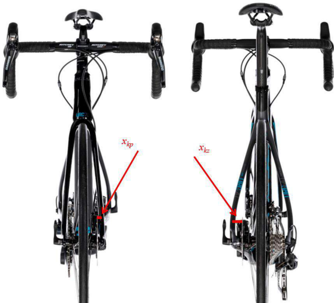
Obrázek 9.8: Vzdálenost nositelek tečných sil na kotouči od uchycení třmenu k rámu [75]
