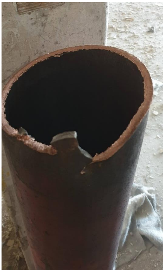
Obr. 10 Tlaková láhev po odstřelu (zdroj vlastní)
