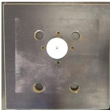
Obr. 6.18 Podložka pod propustoměr
