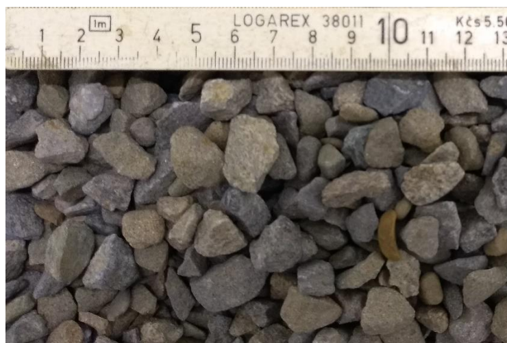
Obr. 6.21 Štěrsk použitý pro zajištění rovnoměrného rozdělení proudu
