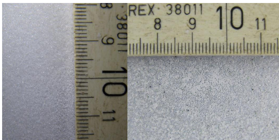
Obr. 6.2 Skleněné kuličky: vlevo – 0,2 mm, vpravo – 0,5 mm (Hala, 2020)
