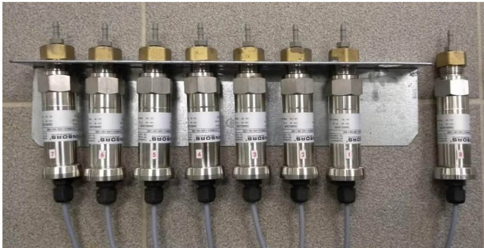
Obr. 6.26 Sensory pro měření tlaků podél průsakové cesty a větších průtoků
