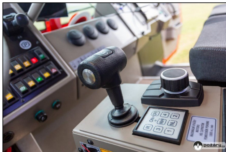
Obrázek 3.19 - Řadící páka systému Tatra NORGREN1 [9]
