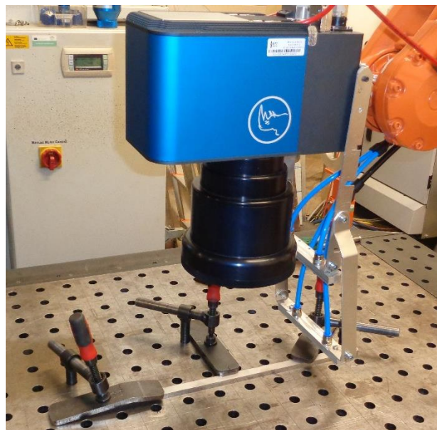
Obr. 37 Svařování pásku na metalografické výbrusy
