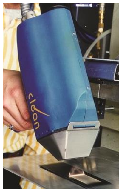
Obr. 13 Ruční laserové čištění provoz, [14]
