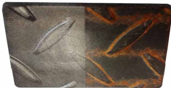
Obr. 14 Laserové čištění od koroze [23]
