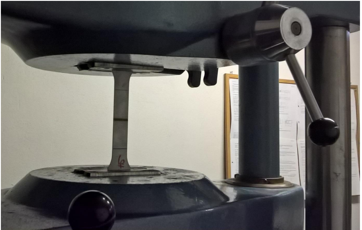
Obr. 39 Ukázka z tahové zkoušky
