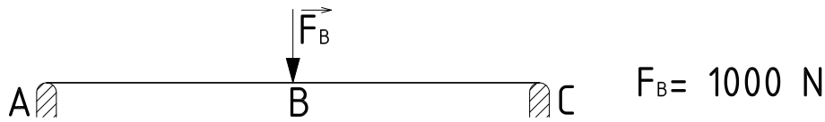
Obrázek 5.16: Prostě uložený prut a uprostřed zatížený silou
