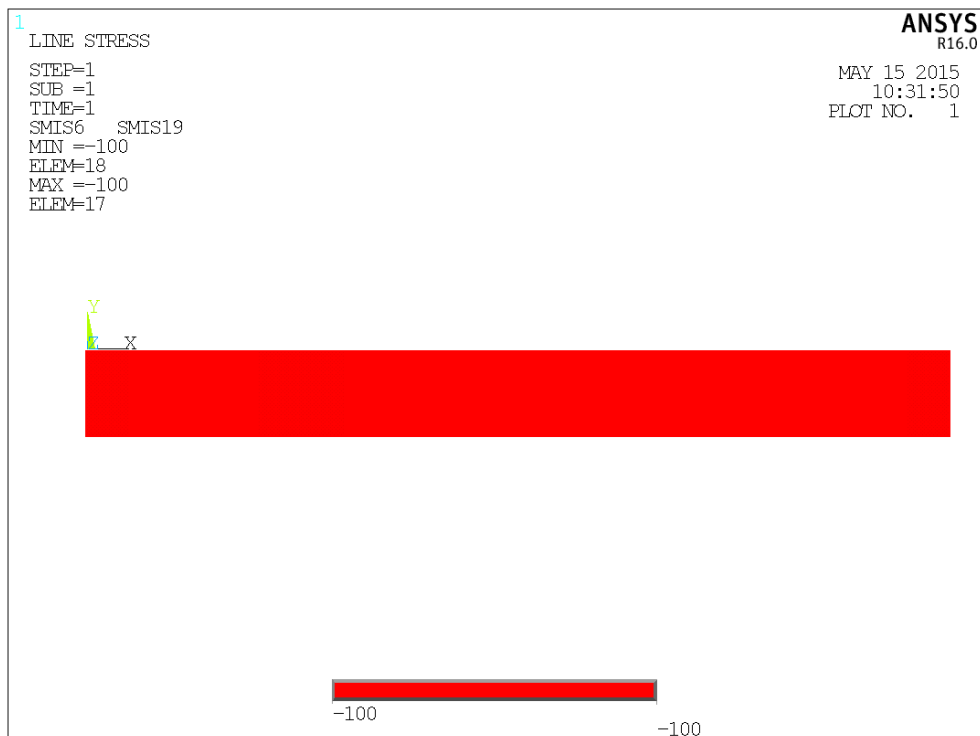
Obrázek 5.10: Posouvající síla vetknutého prutu
