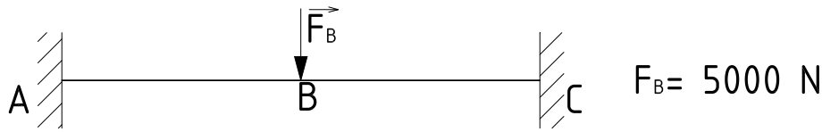
Obrázek 5.15: Prut oběma konci větknutý uprostřed zatížený silou
