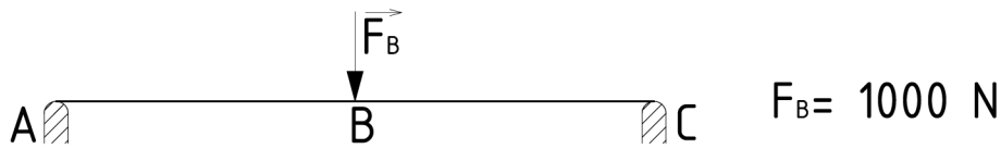
Obrázek 5.16: Prostě uložený prut a uprostřed zatížený silou
