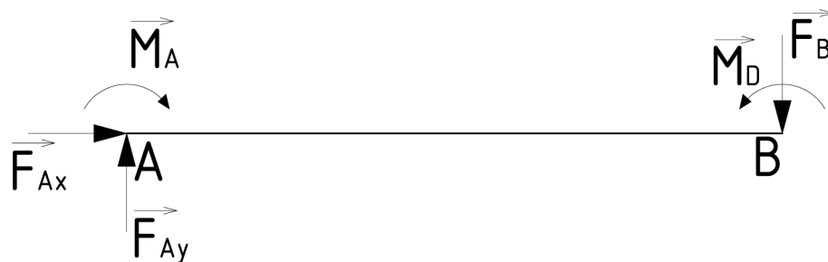
Obrázek 5.4: Úplně uvolněný prut s doplňkovým momentem
