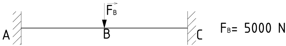
Obrázek 5.15: Prut oběma konci větknutý uprostřed zatížený silou
