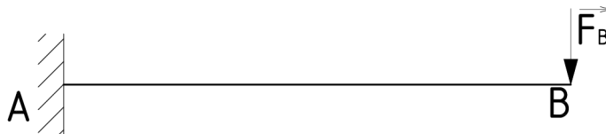
Obrázek 4.6: Vetknutý prut na volném konci zatížený silou
