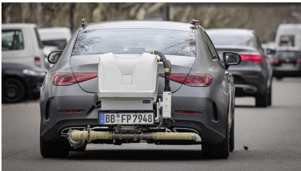
Obr. 2 Měření emise v reálném provozu [18]
