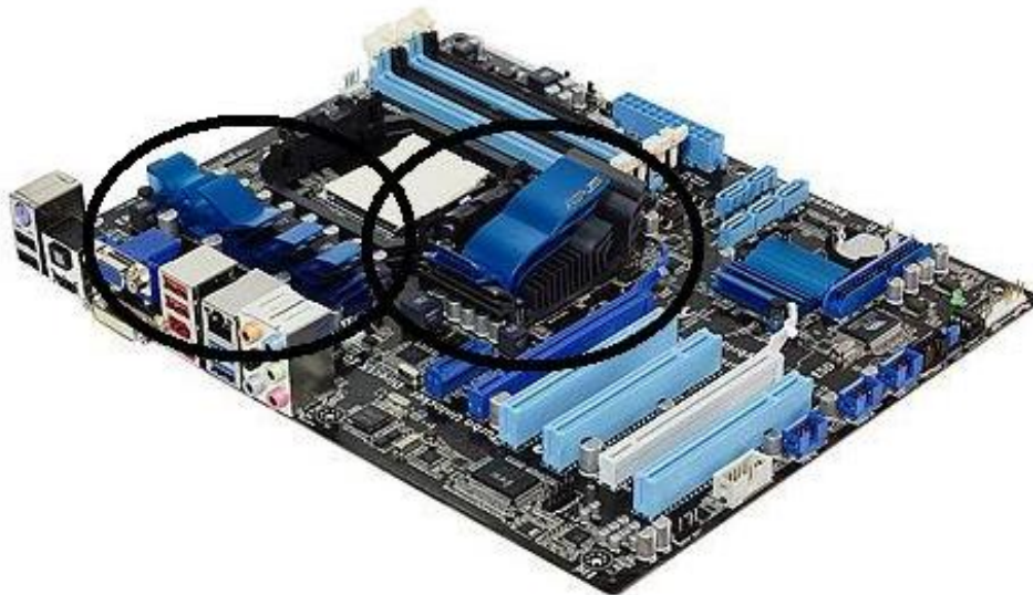
Obrázek č.4: Vhodně dimenzované chlazení (Asus M4A88T-V EVO/USB3)
