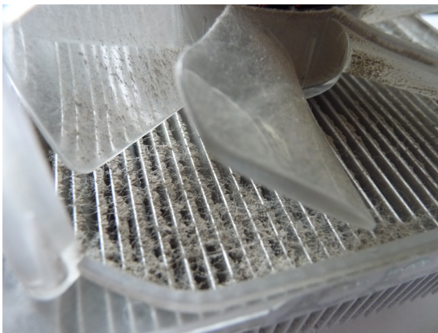
Obrázek č.9 CPU chladič zanesený prachem
