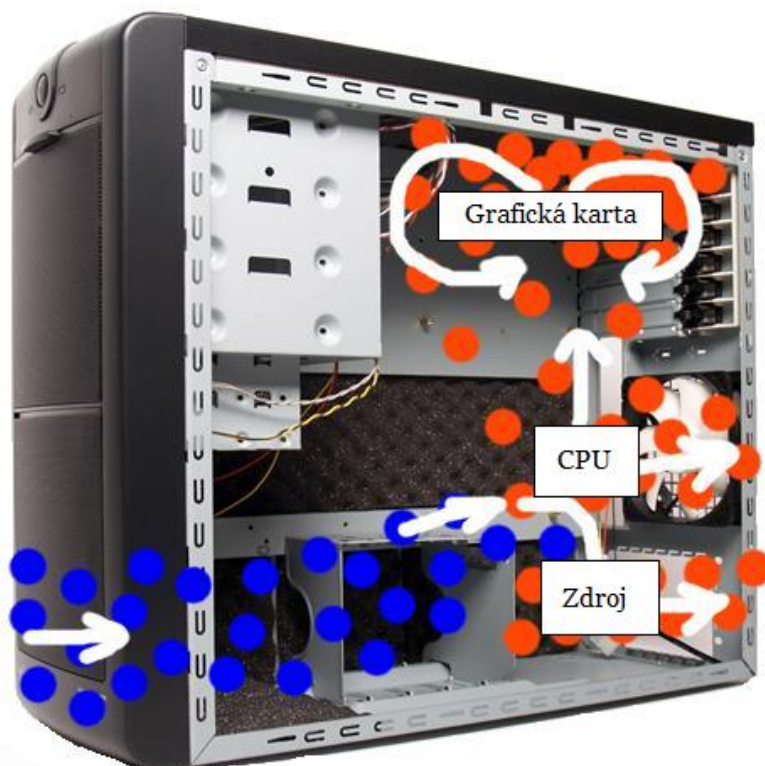
Obrázek č.8 Nevhodné řešení průtoku vzduchu počítačovou skříní
