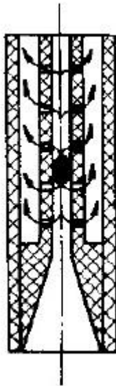
Obr. 2.3 - 4 Štěrbínová zhášecí komora s pomocnými kanály[5]
