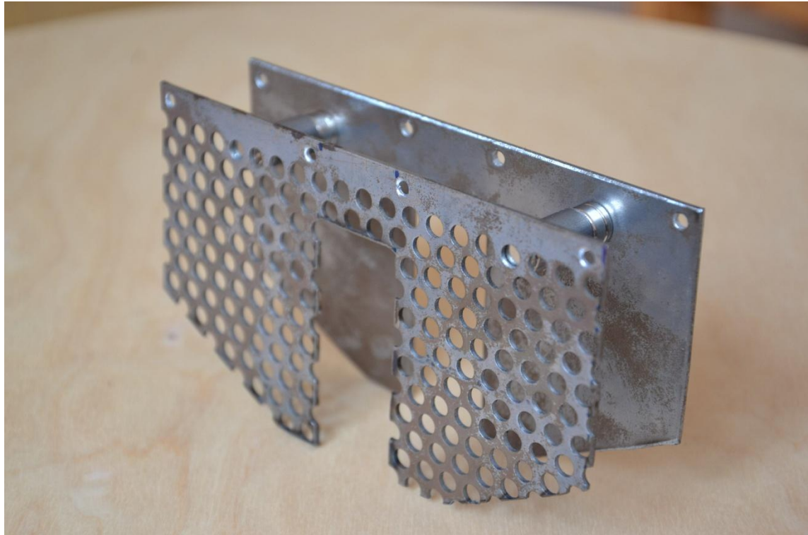
Obr. 4.4 - 2 Magnetický obvod (samostatně)
