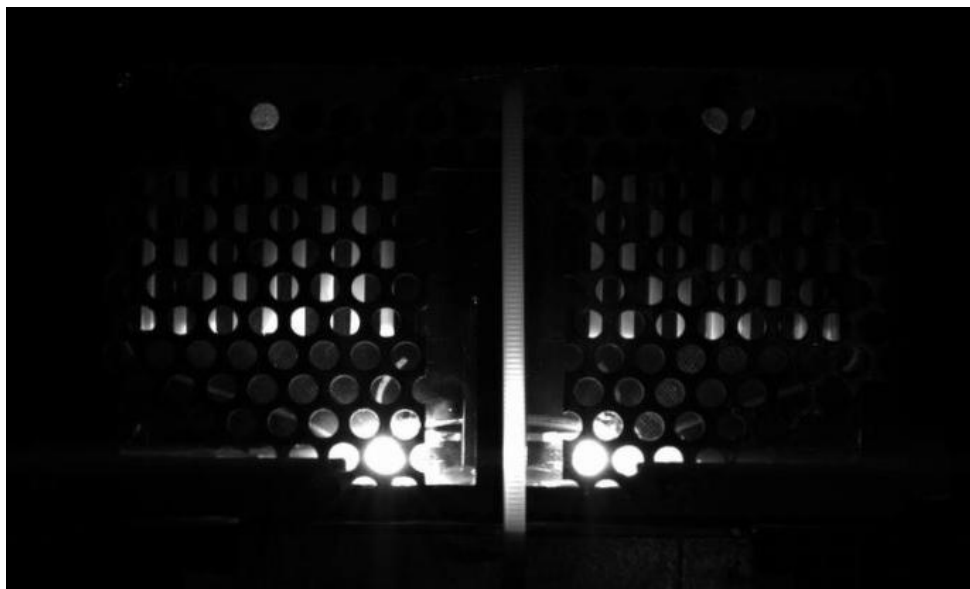
Obr. Vznik oblouků mezi kontakty
