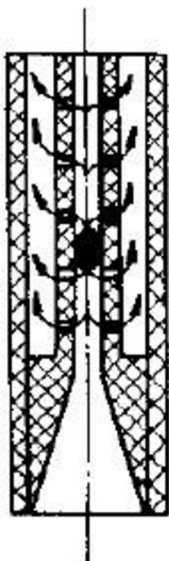
Obr. 2.3 - 4 Štěrbinová zhášecí komora s pomocnými kanály[5]
