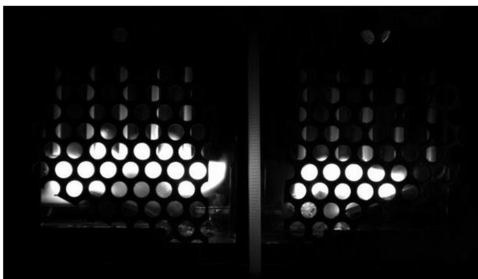
Obr. Oblouky se odtrhly od kontaktů a přechází mezi žebra komory
