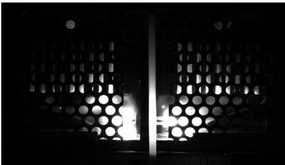
Obr. Oblouky nepřechází na "arc-runners" a zůstávají mezi kontakty (oblouky nezhasínají)
