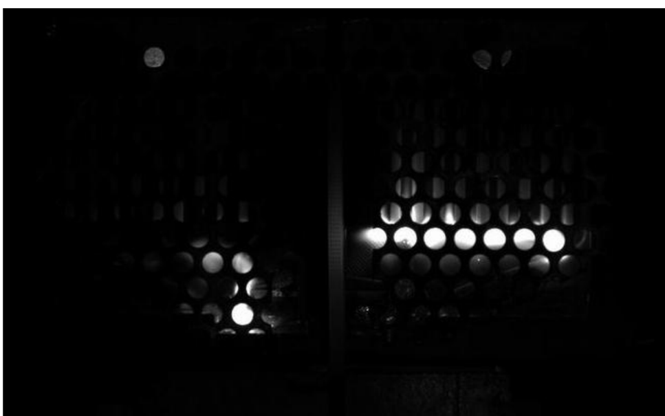
Obr. Oblouk napravo se dostal z kontaktů a zdržuje se na počáteční hranici žeber komory (oblouky zanikají)
