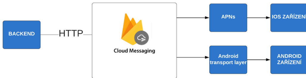
Obrázek 3.1: Infrastruktura doručení notifikací firebase messaging
