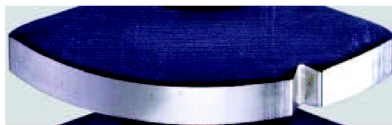
Obr.10 Jakost střížné plochy u přesného stříhání [4]
