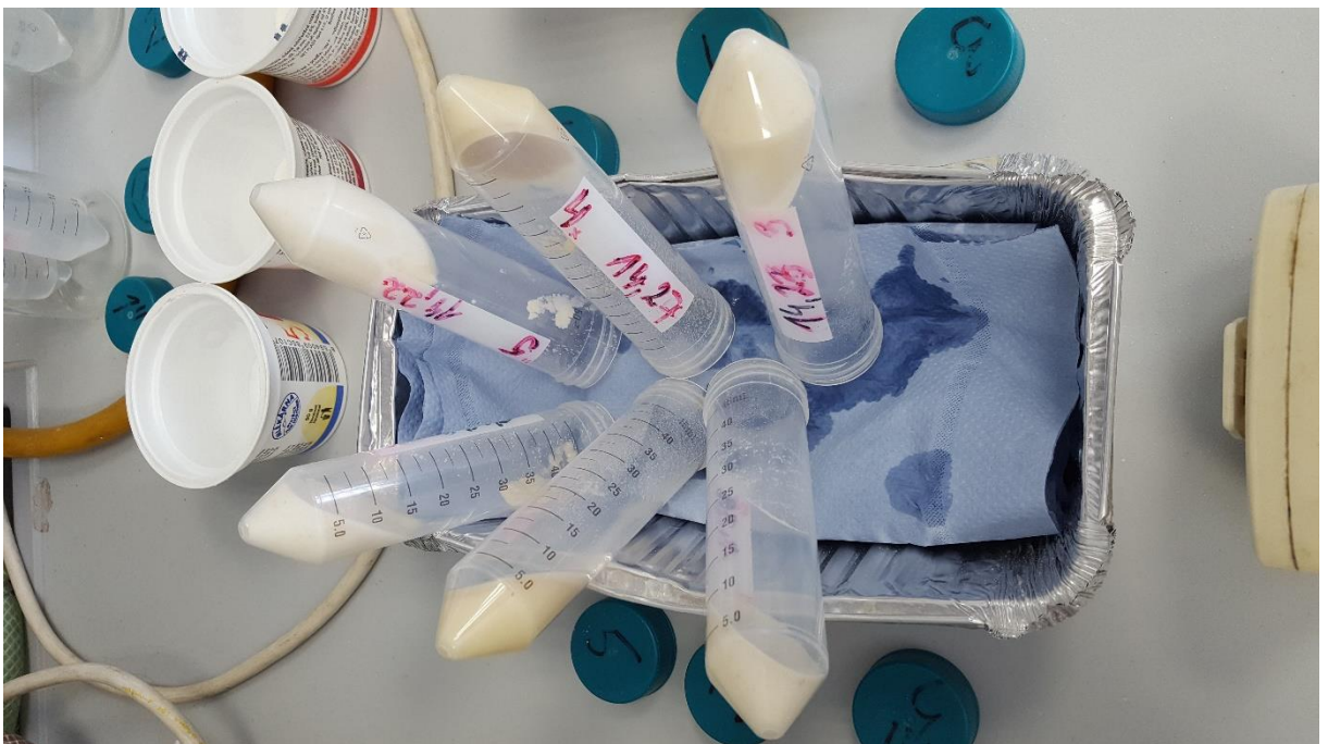
Obrázek 2 – Nezbytné odležení kyvet se vzorky po centrifugaci před závěrečným vážením (Autor diplomové práce, 2018)
