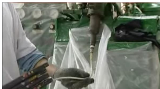
Obr. 15 Plnění rámu pěnou [16]
