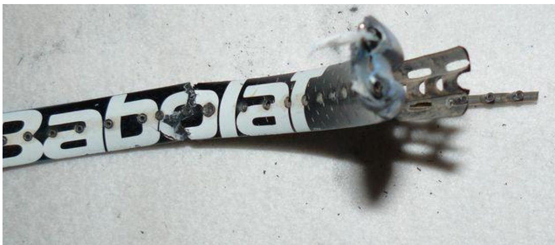
Obr. 27 V místě lomu 1 jsou vlákna vytržena.
