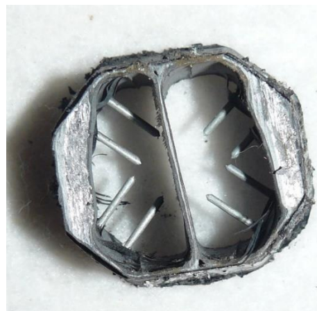
Obr. 34 Vzorek 2.2 - Dvě strany vzorku jsou rozšířeny vrstvou slitiny hliníku.
