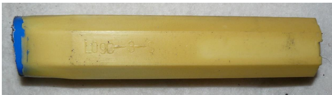
Obr. 21 Vzorek 1.3 - Velikost osmihranu je dána množstvím pryskyřice.
