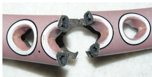
Obr. 38 Vzorek 2.6 - Řez okem v horní části hlavy vzorku 2
