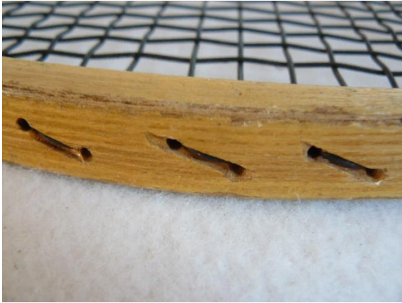
Obr. 12 Díry pro výplet jsou umístěny střídavě
