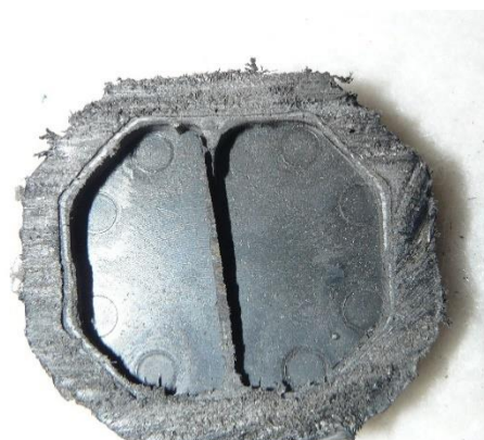
Obr. 33 Vzorek 2.1 - Vrstva grafitu je napojena na uzávěr
