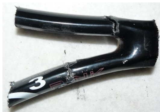
Obr. 41 Detail krčku vzorku 2 s lomy 2 a 3
