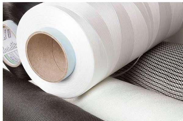
Obr. 5 Vláknó Innegra navinuté na ruličce [12]
