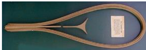
Obr. 11 Klínek je umístěn do místa srdce rakety [15]
