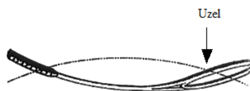
Obr. 10 Uzel zůstane i při prohnutí tenisové rakety na stejném místě [14]
