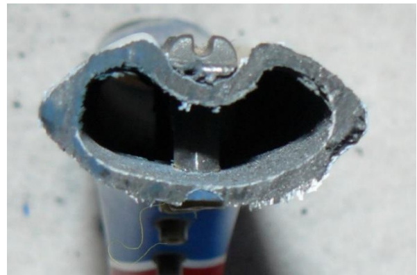
Obr. 25 Vzorek 1.6 - Profil hlavy tenisové rakety
