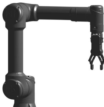
Obrázek 5.1: Konečný model UR5e s gripperem
