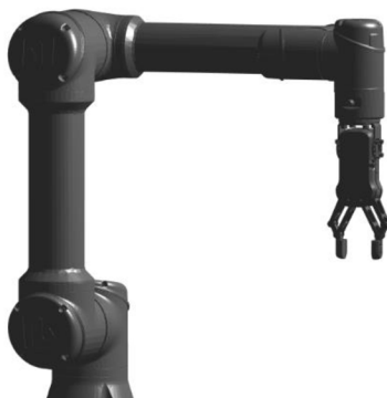
Obrázek 5.1: Konečný model UR5e s gripperem
