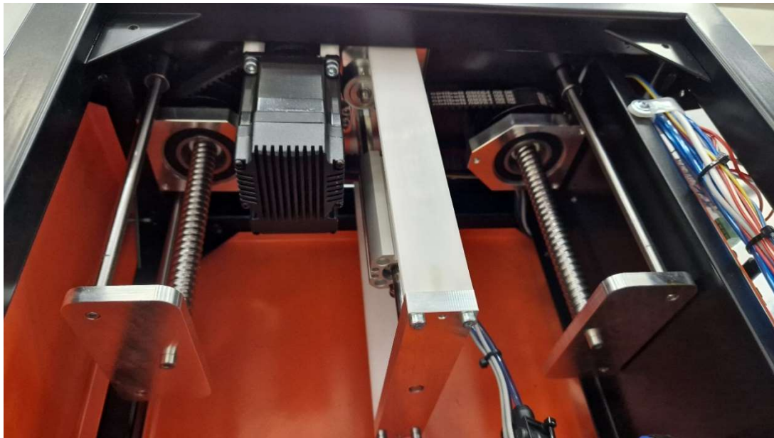
Obr. 63 - Pohon a vedení osy výtahu ze spodního pohledu
