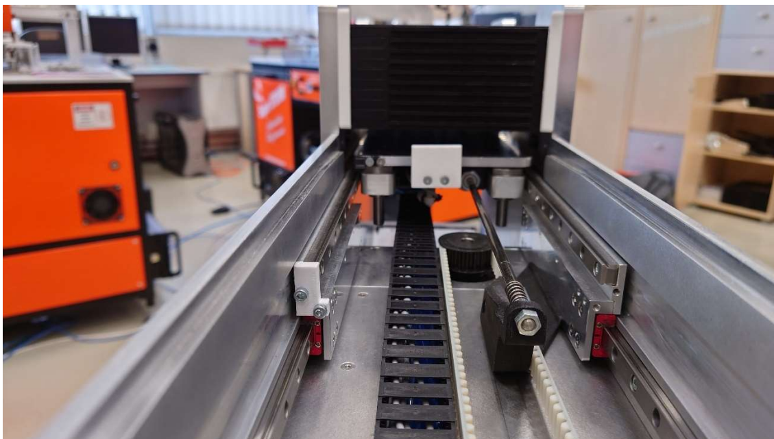
Obr. 64 - Lineární vedení a pohony osy dopravníku
