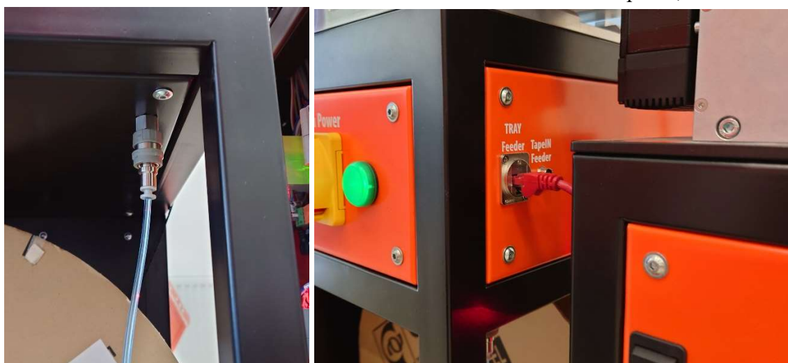
Obr. 77 – Připojení stlačeného vzduchu a komunikačního rozhraní Ethernet
