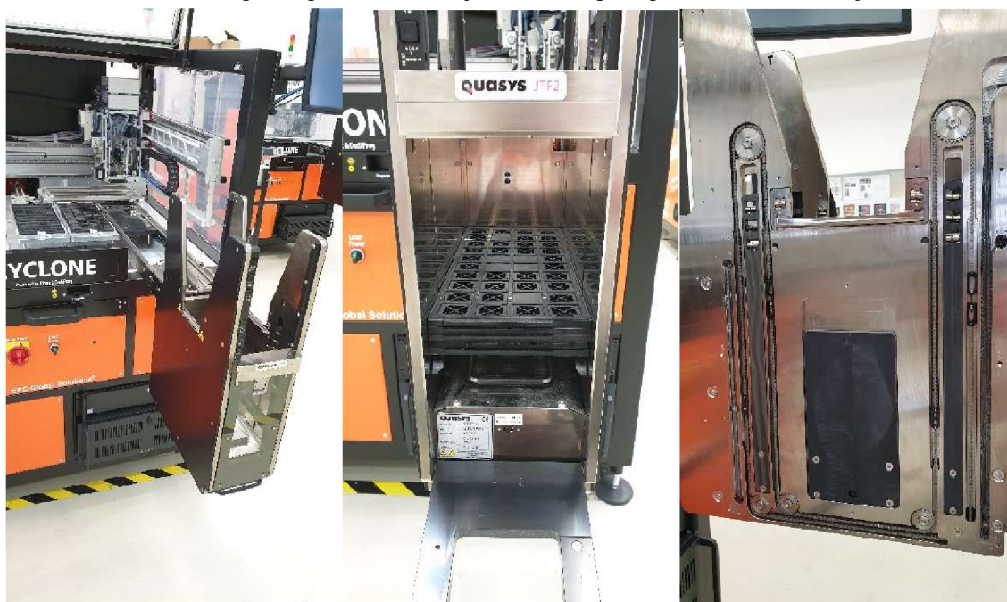
Obr. 2 - Quasys JTF2 umístěn v automatu CYCLONE a jeho řetězové rozvody
