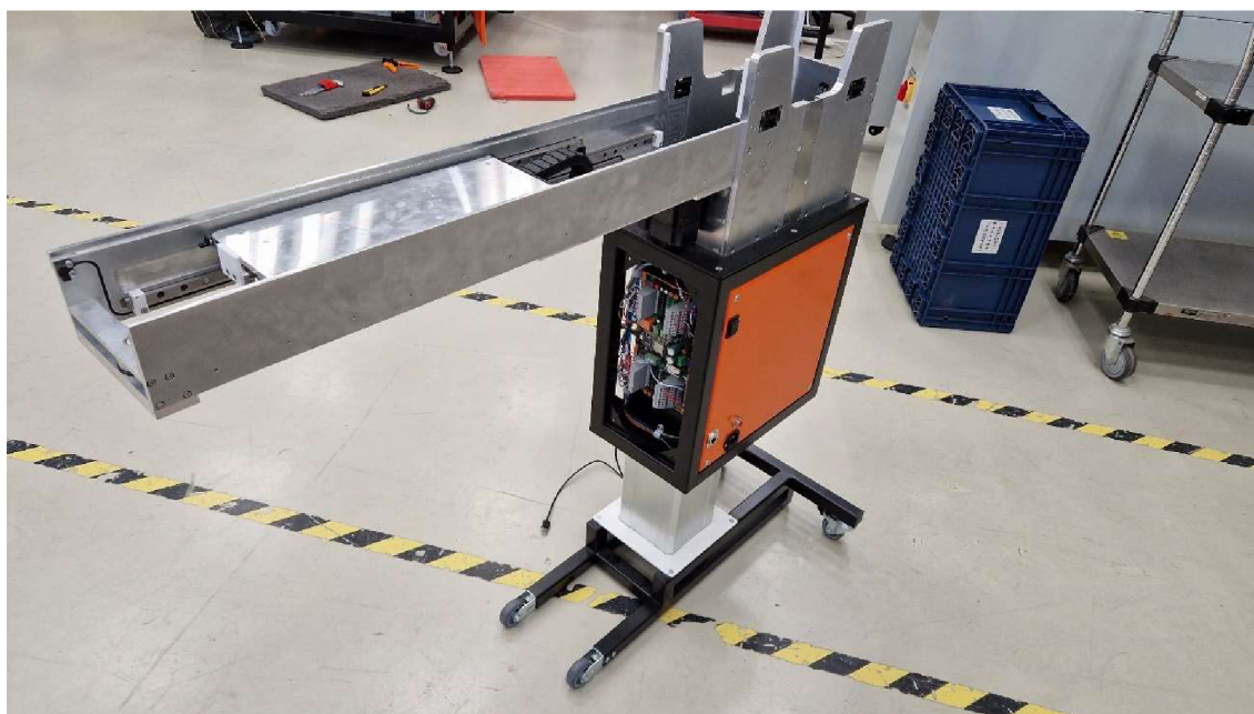
Obr. 58 - Sestavený automatický dávkovač plat
