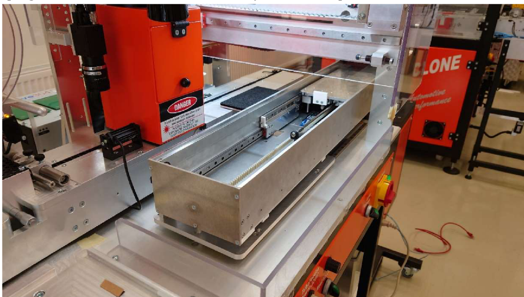
Obr. 75 – Zajetí automatického dávkovače plat v zaváděcí výšce
