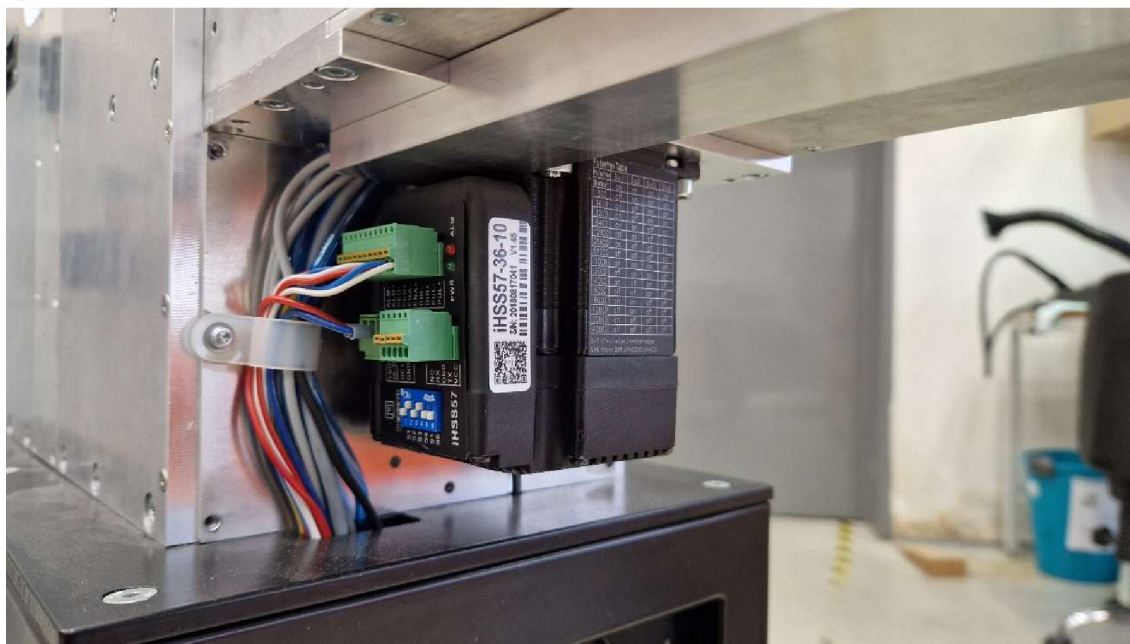
Obr. 68 - Nastavení a zapojení motoru pohonu dopravníku
