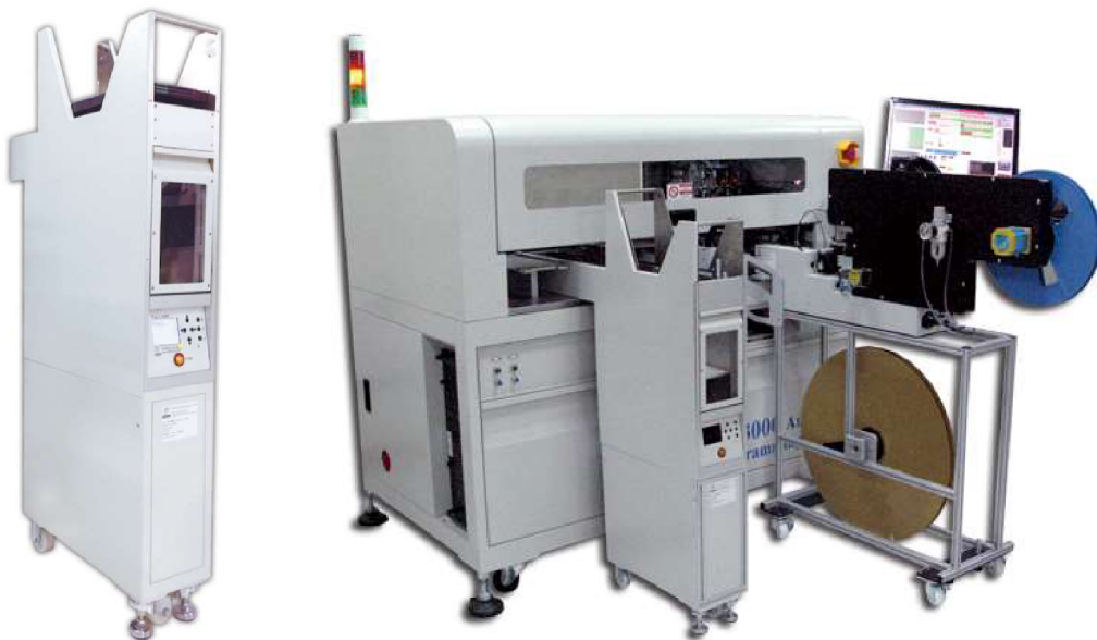
Obr. 3 – Auto Tray-250 osazený v automatu DP3000 spolu s Tape&Reel Machine [3]
