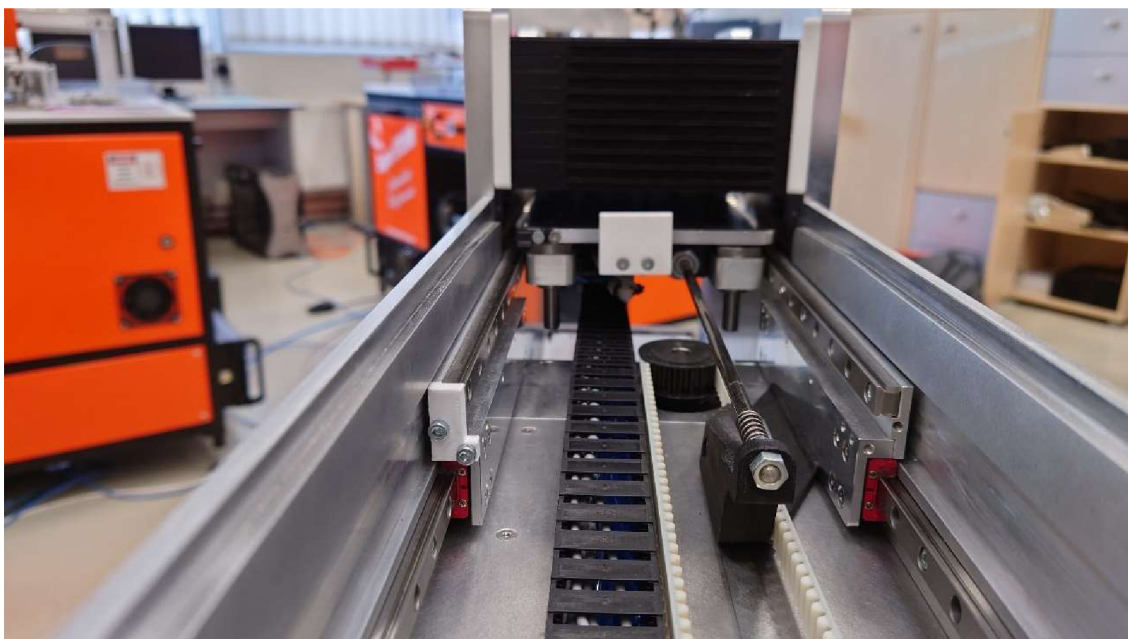
Obr. 64 - Lineární vedení a pohony osy dopravníku
