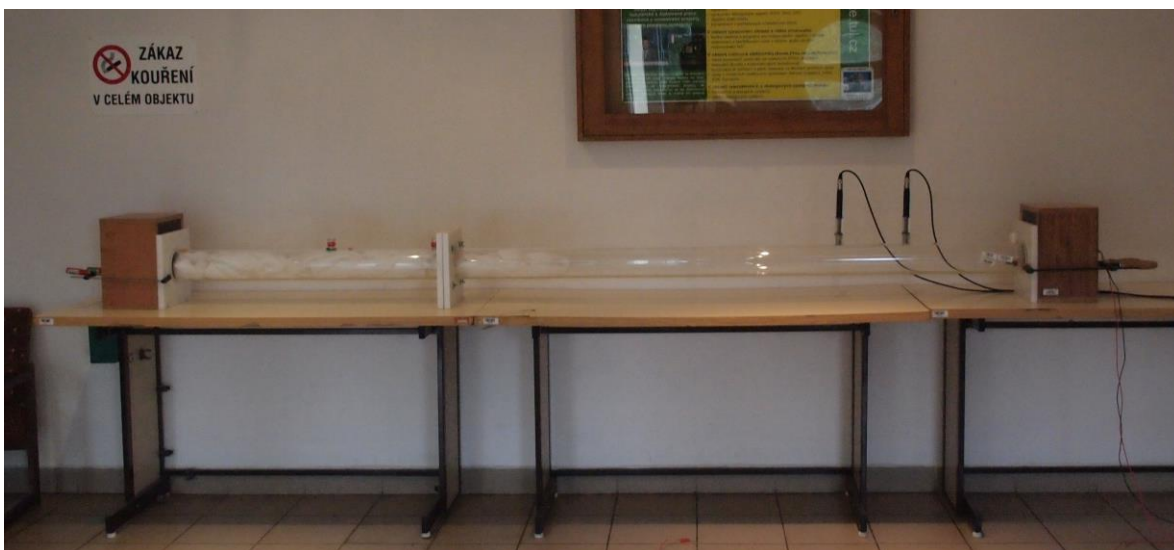
Obr. 24 – Realizace měřicí instalace pro verifikaci impedance bočnicku pomocí dvoumikrofonové metody
