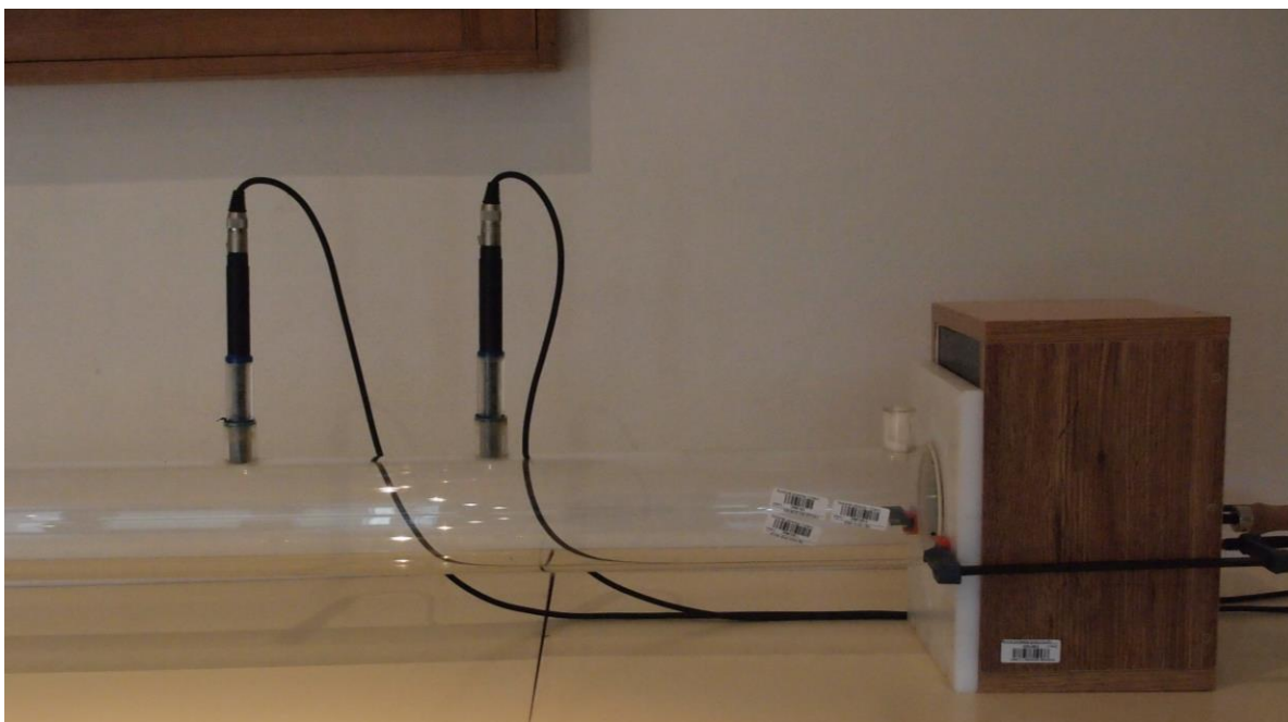
Obr. 23 – Fyzické připojení mikrofونů k impedanční trubici – pro dostupné modely měřicích mikrofونů byly vyrobeny odpovídající redukce tak, aby mikrofony nezasahovaly do vnitřního objemu trubice
