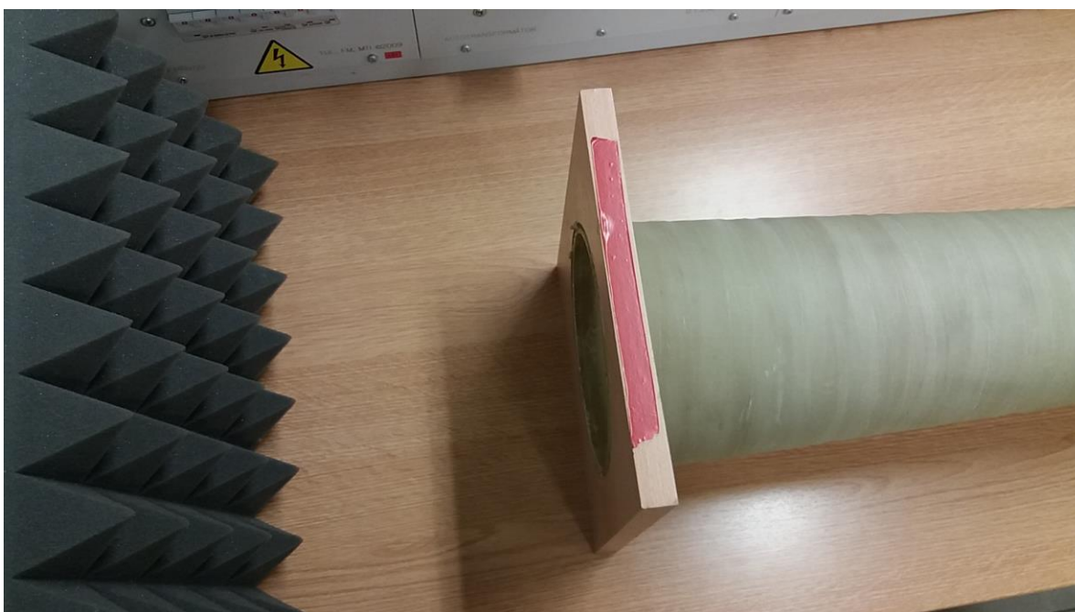
Obr. 28 – Umístění difúzních molitanových jehlanů proti vývodu akustické horny
