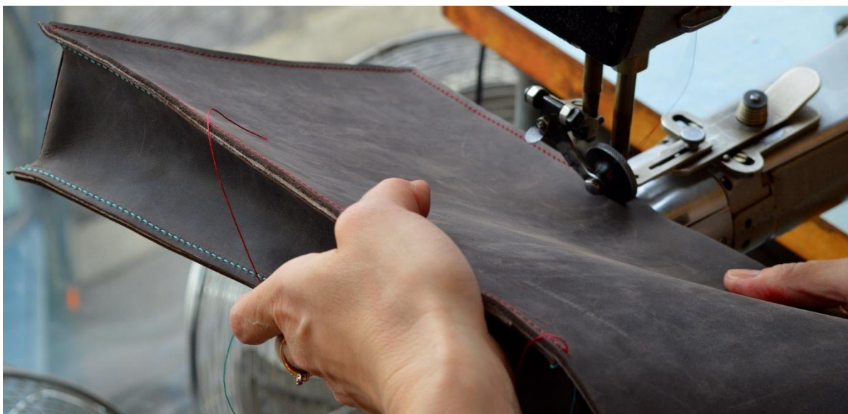
Obrázek 28 – Sešítí zadního dílu a bočnic s dnem.
