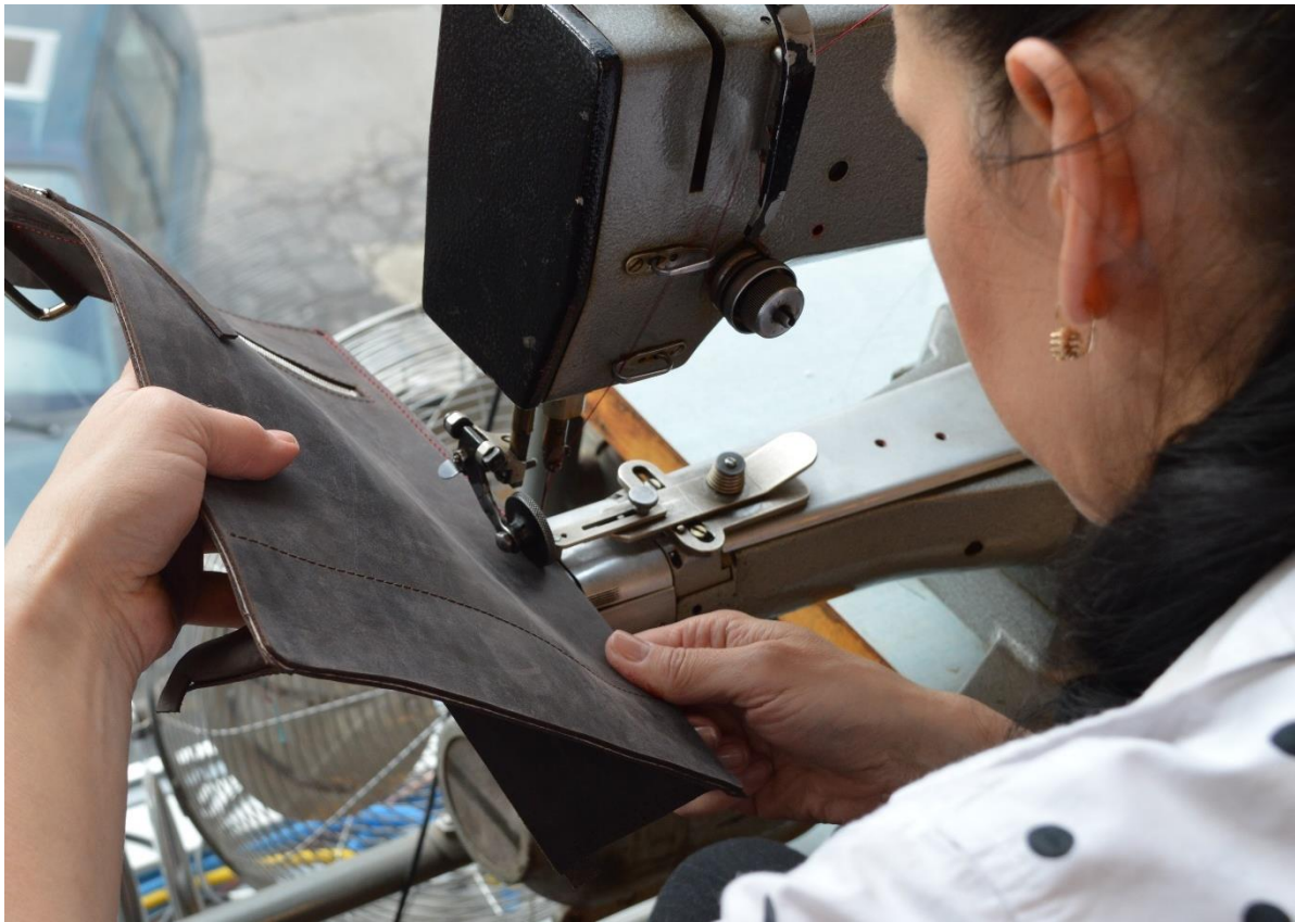
Obrázek 27 – Sešítí hotového předního dílu a bočnic s dnem.
