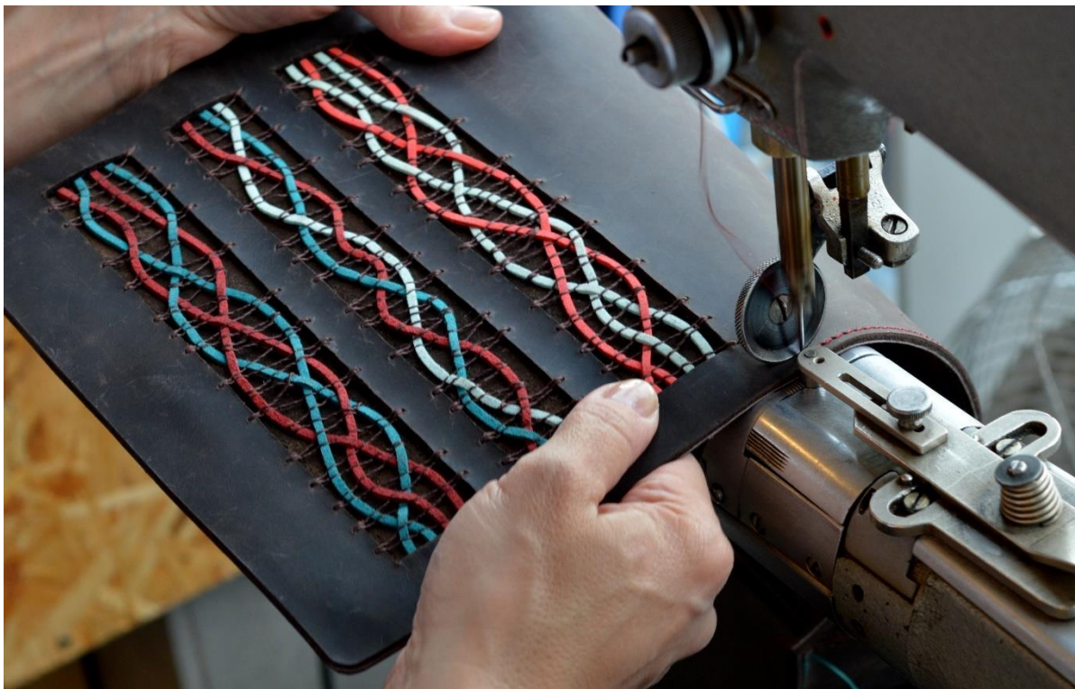
Obrázek 30 – prošití víka s paličkovanou krajkou.
