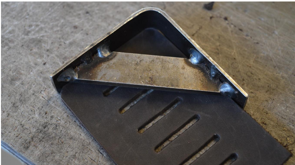
Obrázek 32 – Detail vysekávacího nože.
