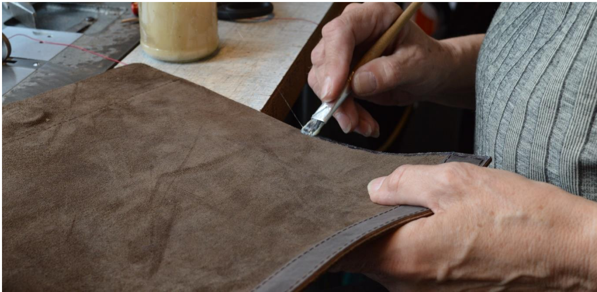
Obrázek 25 – Lepení předního dílu k bočnici s dnem
