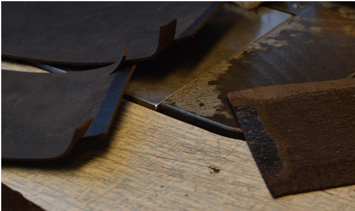
Obrázek 23 – Slepění bočnice a dna.
