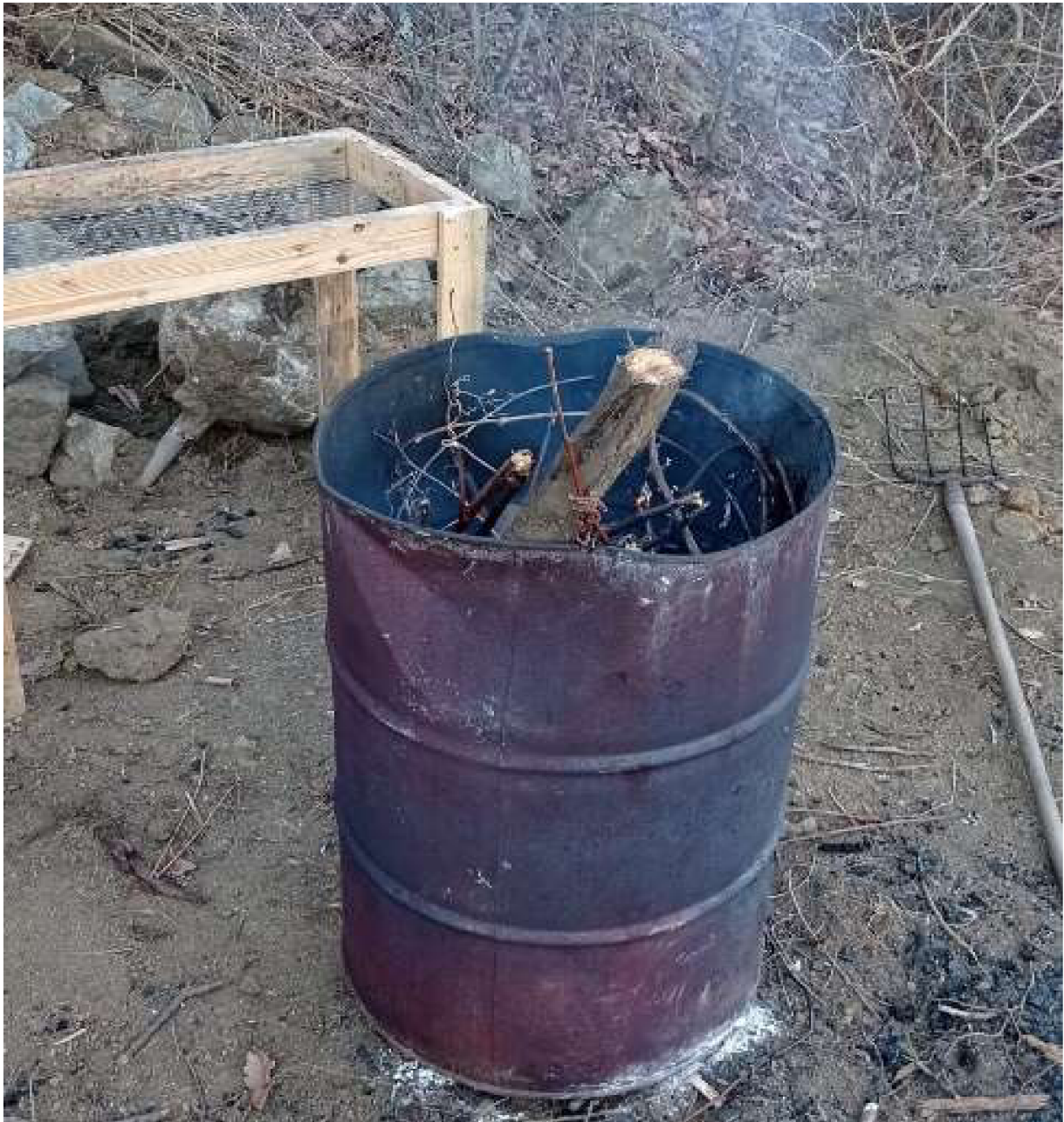
Obrázek 4 - Plechový sud použitý pro výrobu vzorků 1, 2 a 3. Na snímku je příprava vzorku č. 3, v pozadí je vidět sito použité pro oddělení frakce 0-15 mm.
