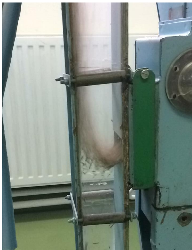
Obrázek 8: Vzduchový separátor využitý k separaci prachových částic od čistých semen v DLF-TRIFOLIUM Hladké Životice, s.r.o.
