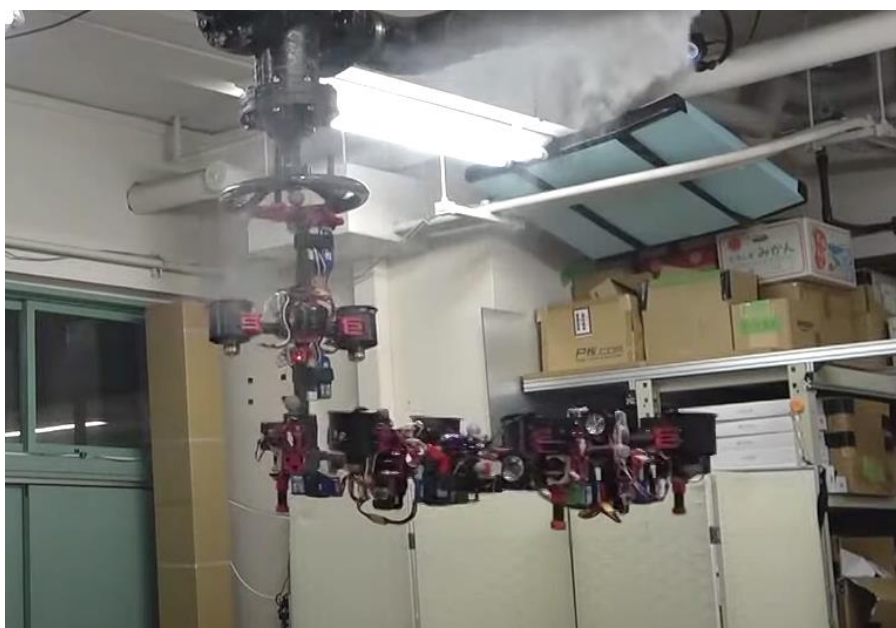
Obr. 20: Konfigurácia pri uzatváraní ventilu [10]
