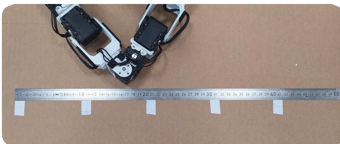
Obr. 56: Značky na testovacej rovine, rozteč 10 cm
