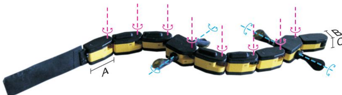
Obr. 22: Robot ACM-R5H schopný splývania s hladinou vody [11]
