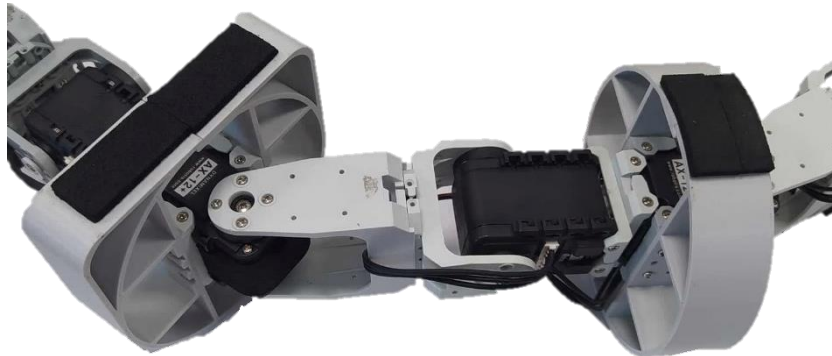
Obr. 62: Penové podložky nalepené na spodnej strane prstencov
