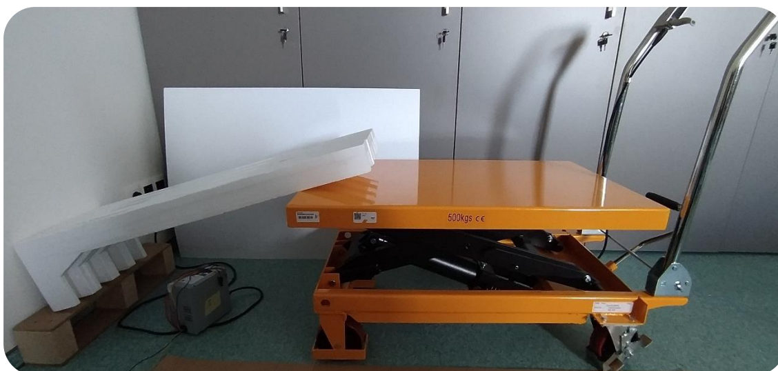
Obr. 55: Testovacia zostava s nastaviteľným sklonom
