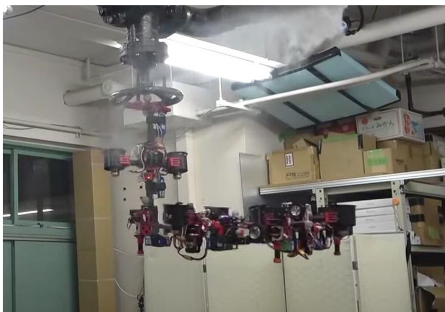
Obr. 20: Konfigurácia pri uzatváraní ventilu [10]
