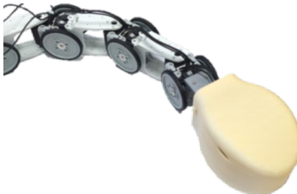
Obr. 67: Detail planárneho robotického hada
