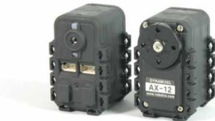
Obr. 27: Aktuátor Dynamixel AX-12 [12]
