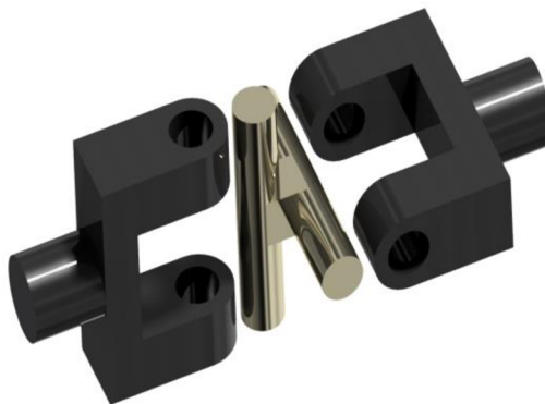
Obr. 37: Rozložený kardanový spoj (dve vidlice a kríž v strede)
