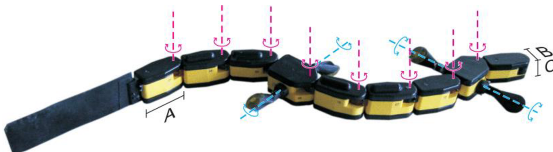
Obr. 22: Robot ACM-R5H schopný splývania s hladinou vody [11]
