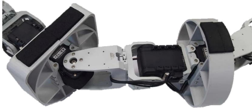
Obr. 62: Penové podložky nalepené na spodnej strane prstencov
