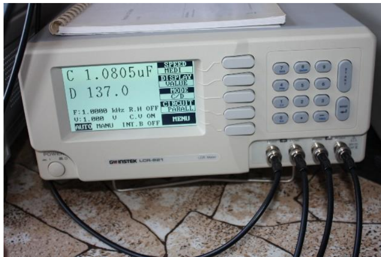
Obr. 5p Impedanční analyzátor LCR metr INSTRUK LCR821
