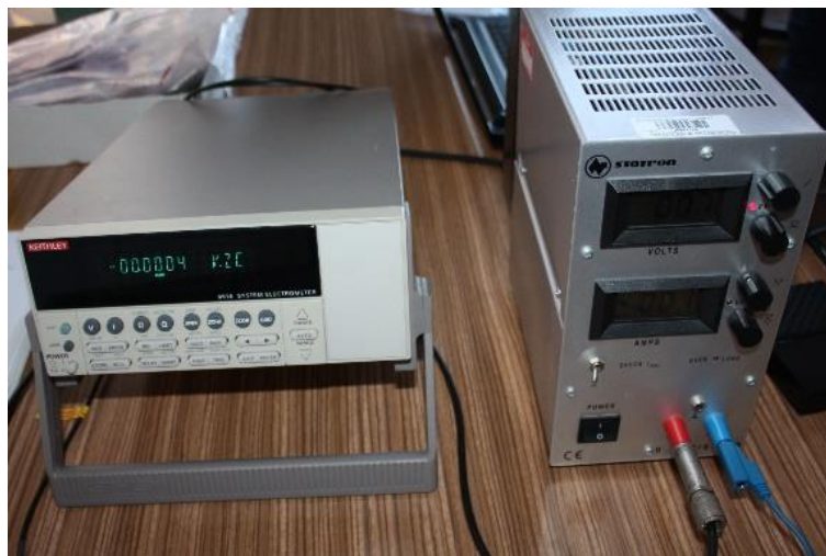
Obr. 6p Elektroměr Keithley 6514 a zdroj Statron 3241.5
