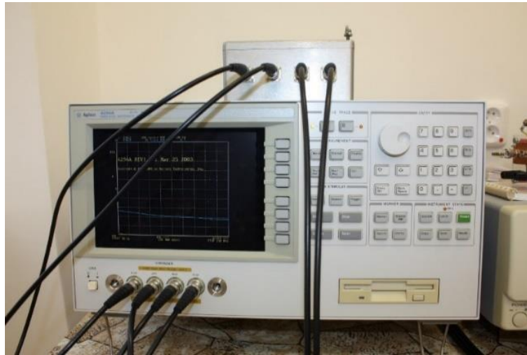
Obr. 4p Impedanční analyzátor AGILENT 4294
