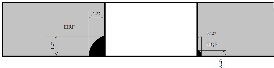
Obr. 7 Typické umístění počátečních trhlin v otvoru pro nýt
