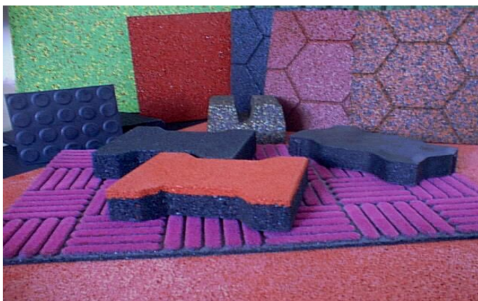
Obr. č. 5: Ukázka rubitové vozovky (PNEUREVUEb)
