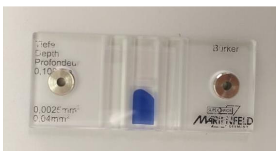
Obr. 8 Vzorek suspenze buněk s přídavkem trypanové modři pro účely počítání buněk.
