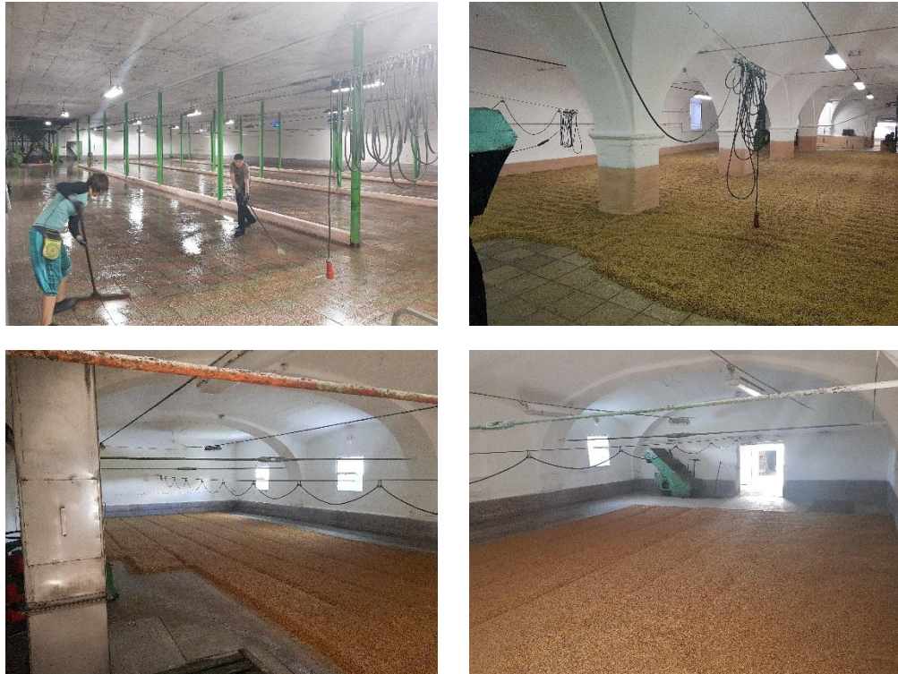
Obrázek 7: Sladovna Kounice disponuje humny, ve kterých se řízeným způsobem nechá naklíčit ječmen, zdroj: archiv autora
