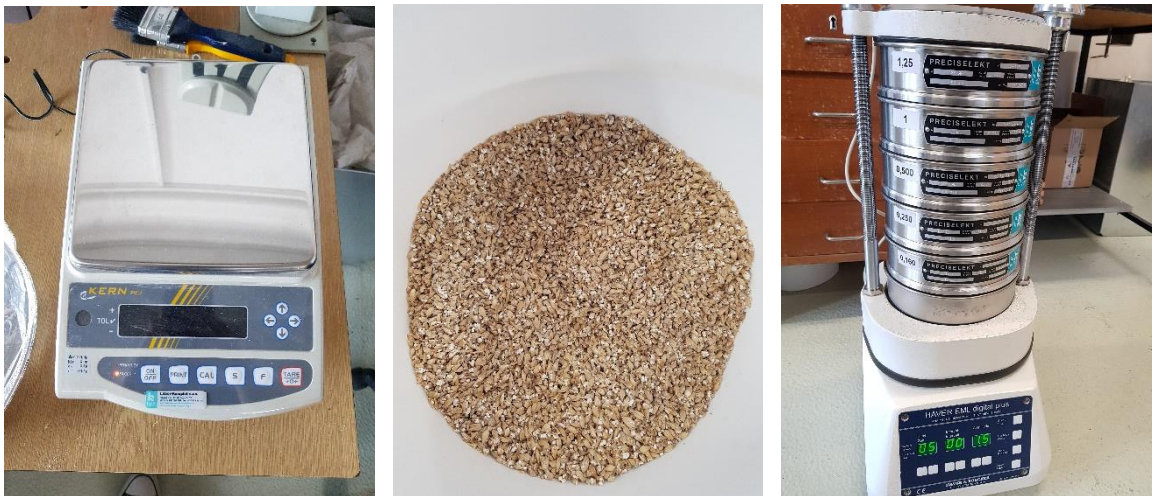
Obrázek 30: Zleva – váha od značky Kern&Sohn, sladový šrot, Sieve Shaker se sítý od značky Haver & Boecker, Zdroj: archiv autora
