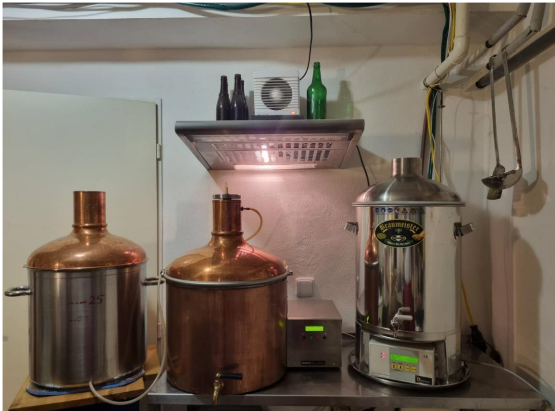
Obrázek 16: Zleva BrauEule II Pro Autobrew (vyslázovací/rmutovací kád' a varní pánev) a Braumeister EXTENDED, Zdroj: archiv autora
