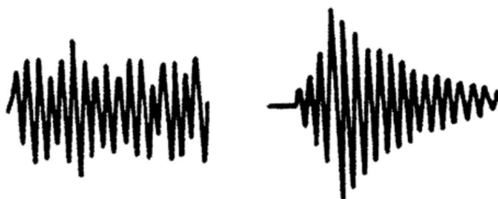
Obr. 3.2: Vizualizace A spojitého a B nespojitého průběhu akustické emise [5]
