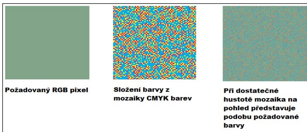
Obrázek 24: Princip rozkladu barev CMYK modelu [40]
