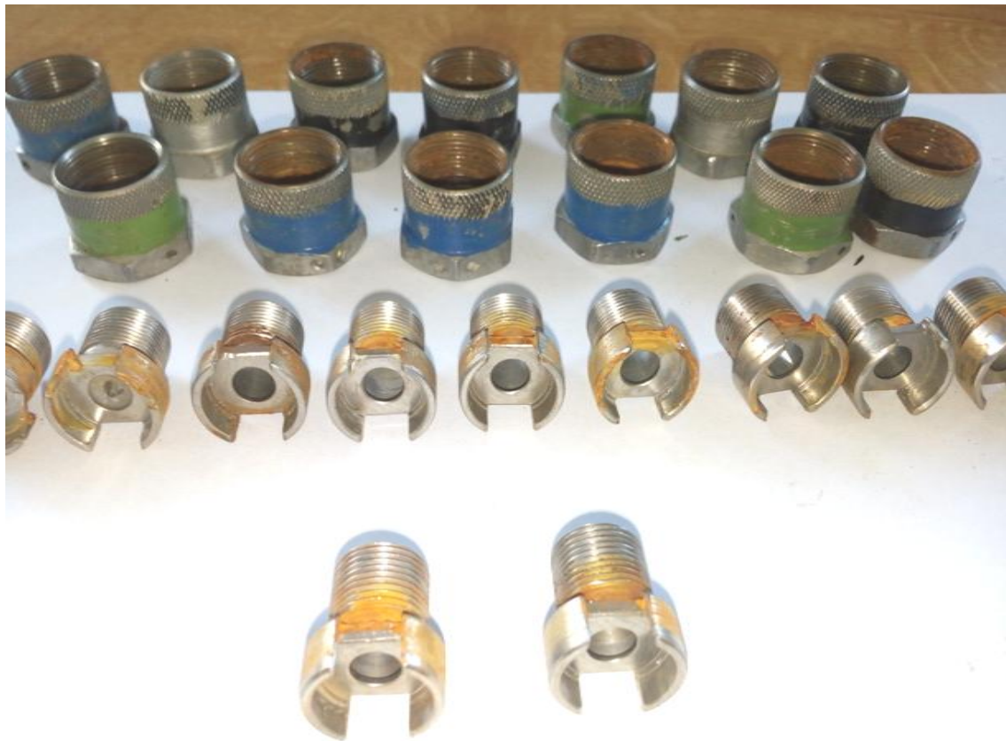
Obrázek 10 Převlečné matice a pouzdra zasažené korozi, Zdroj: vlastní, 2017
