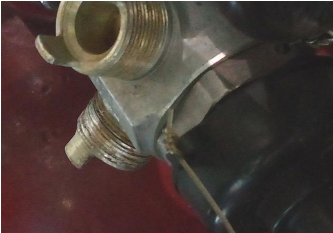
Obrázek 13 Pyrotechnický ventil po demontáži poškozené pyrohlavice, Zdroj: vlastní, 2017
