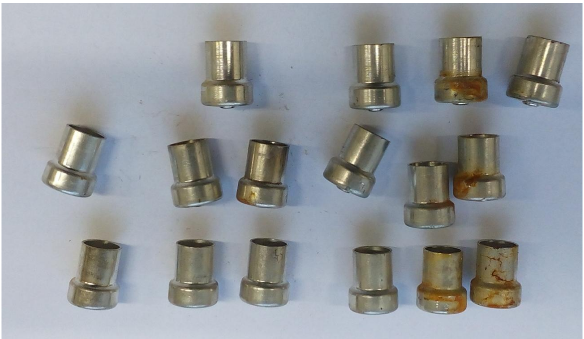
Obrázek 12 Pyropatrony PP-3 po demontáži z pyrohlavic zasažené korozí, Zdroj: vlastní, 2017
