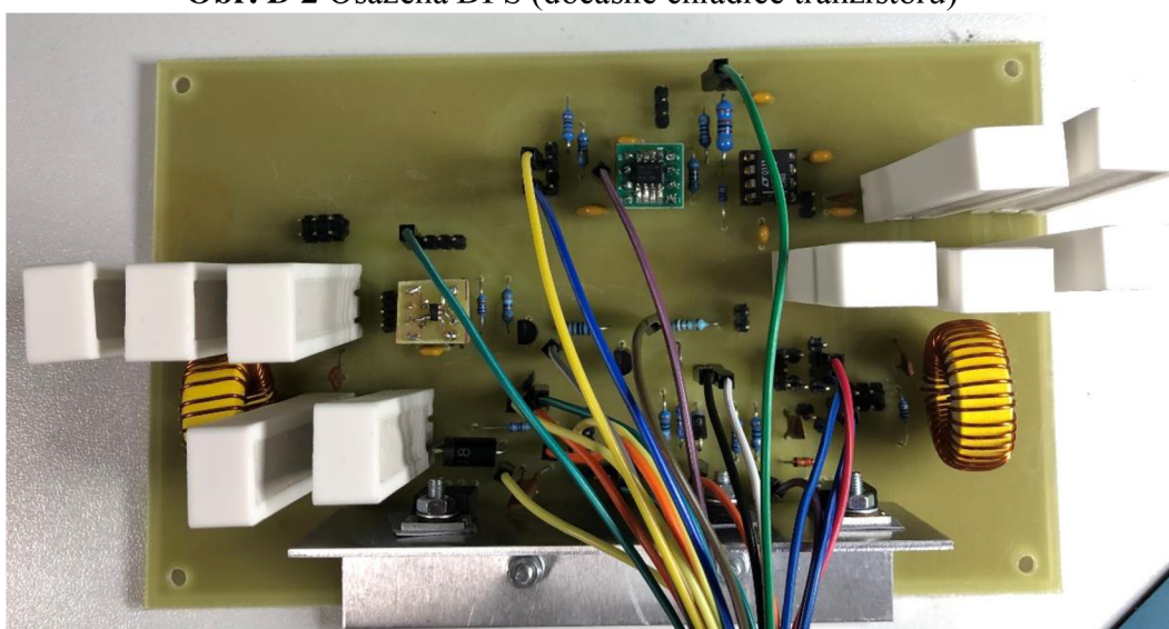
Obr. D 3 Příprava kabeláže na usazení přípravku do šasi (stálý chladič)
