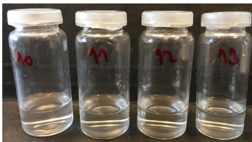
Obrázek 27: Vzorčky se směsí lipidů DOTAP/DPPC v poměru 50/50 po přidání HyA
