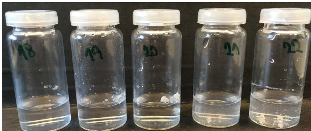
Obrázek 31: Směs lipidů DOTAP/DPPC v poměru 25/75 s přidávkem hyaluronanu 30 mg/l
