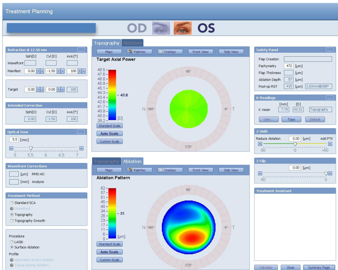
Obr.1 Operační plán pro ATG PRK (na horním obrázku je virtuální záměrná pooperační axiální mapa, na dolním obrázku je profil ablace)
