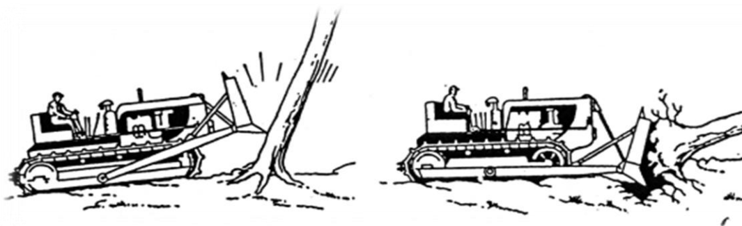
Obrázek 13: Postup při kácení stromů průměru 25 -30 cm
