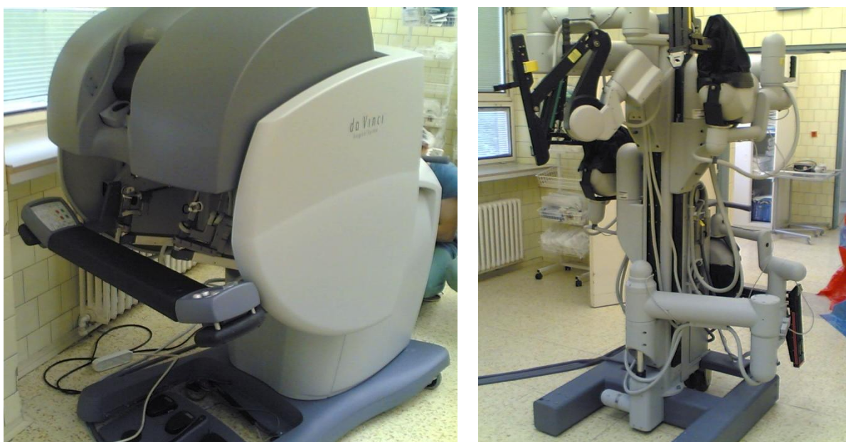
Obr. 4.2 Robotický operační systém daVinci - konzola ovládaná chirurgem (vlevo), robotická ramena držící endoskopickou optiku a dva až tři chirurgické nástroje (vpravo)
