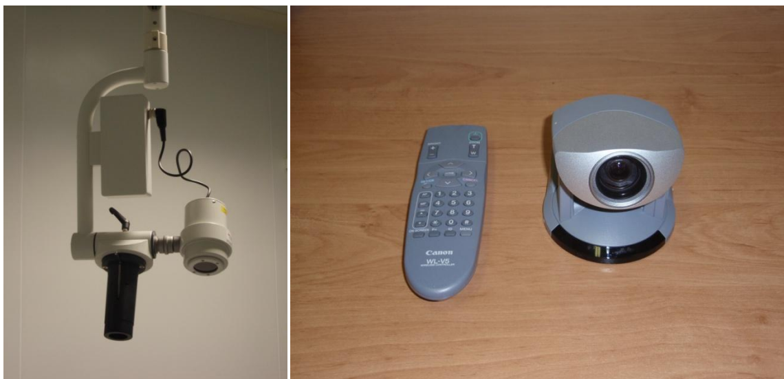
Obr. 6.3 Kamery snímající obraz na operačním sále – kamera Martin Medizin Technik (vlevo), kamera Canon VC-C4 (vpravo)
