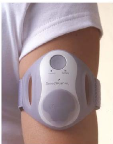
Obr. 4.1 Příklad integrovaného monitorovacího systému umožňujícího přímé měření teploty kůže, teplotního toku kůže, galvanické kožní odpovědi a pohybu (zrychlení).
