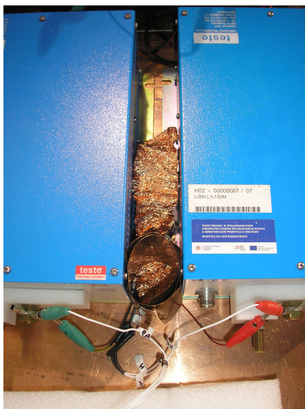
Obr. B.4: Odstínění simulátoru řídicí jednotky
