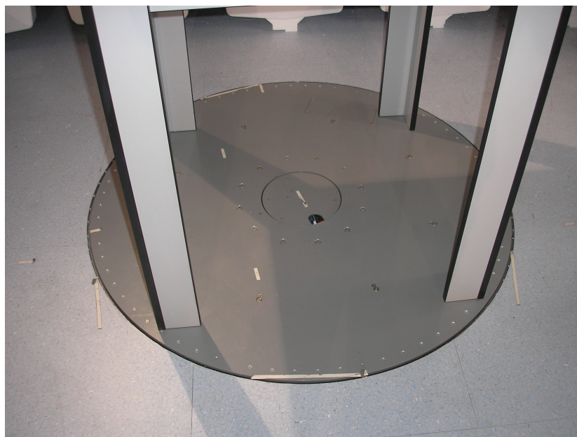
Obr. A.2: 360° otočný systém Faradayovy komory
