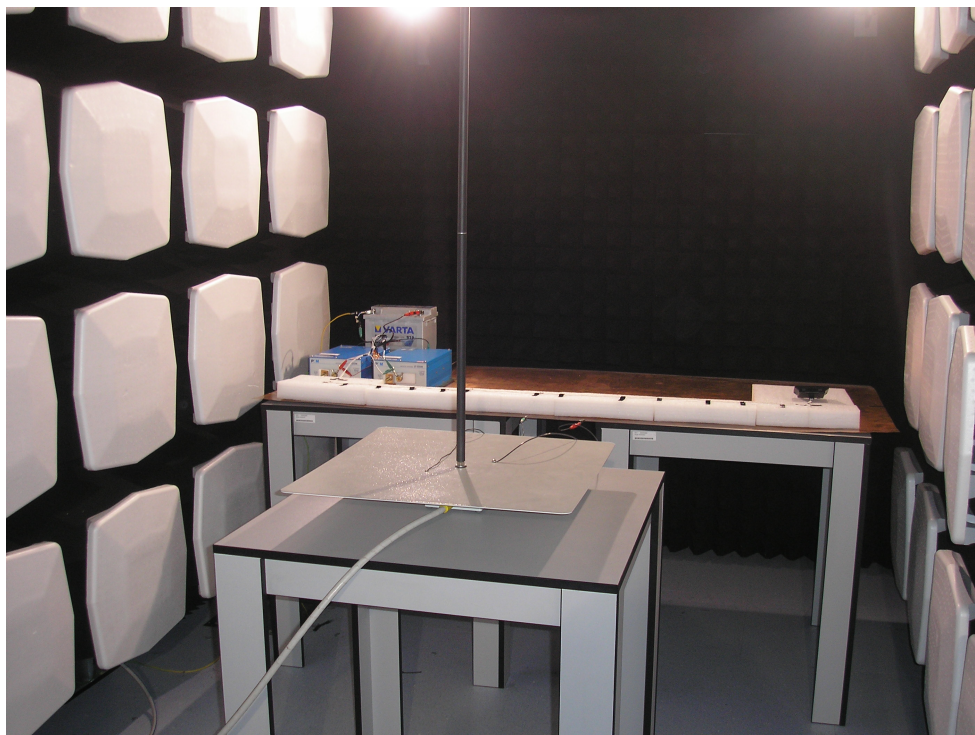
Obr. B.5: Měření vyzařování prutovou anténou
