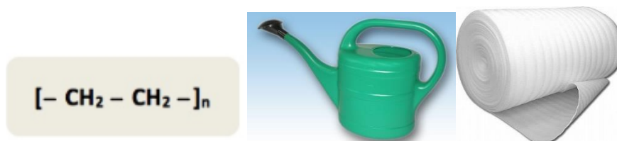
Obr. 3: Strukturální vzorec PE, kropicí konve a kročejová izolace (URL 6, URL 8, URL 9)
