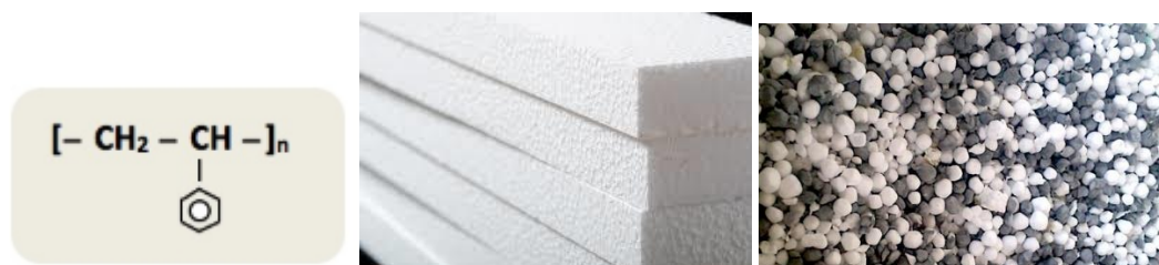
Obr. 7: Strukturální vzorec PS, polystyrenové desky a drcený polystyren (URL 6, URL 13, URL 14)
