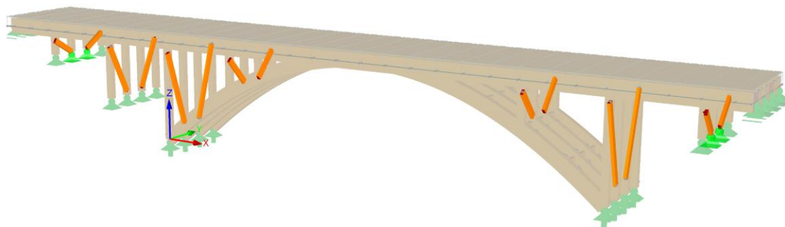
Obr. 30 Diagonály pro horizontální ztužení konstrukce
