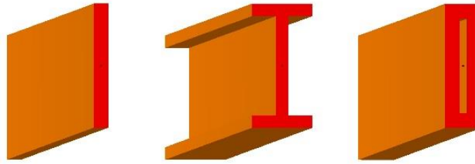
Obr. 4 Nosník profilu I, I s patkami a nosník uzavřený
