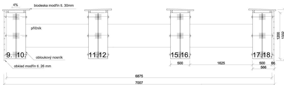
Obr. 42 Konstrukční ochrana obloukových nosníků
