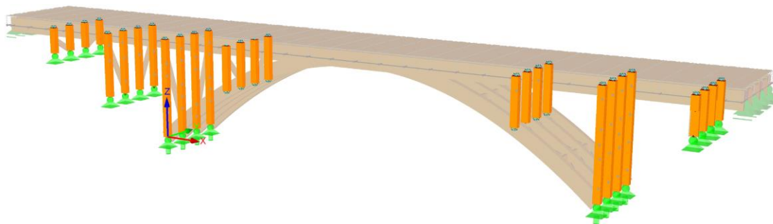
Obr. 27 Uspořádání podpěr po délce mostu
