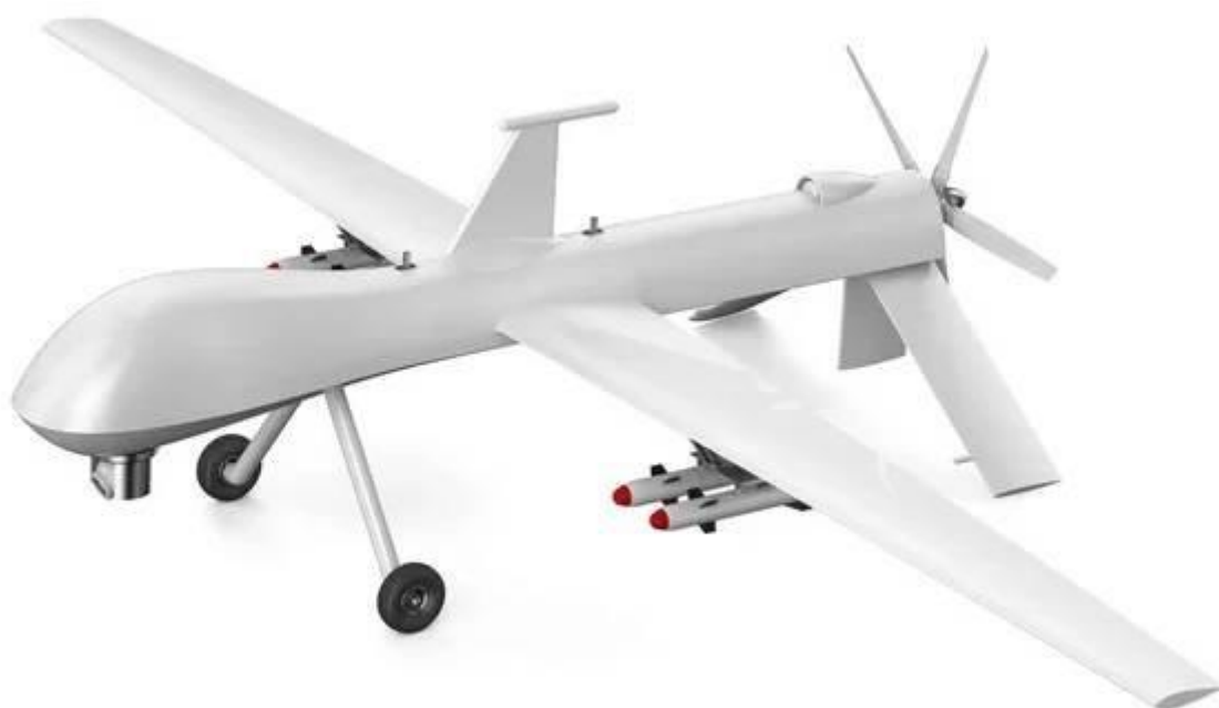
Obrázek 2 - Bepilotní letoun, také nazývaný dron
