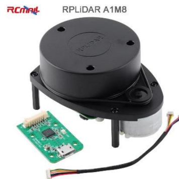
Obrázek 6 - Příklad rotačního LIDARu
