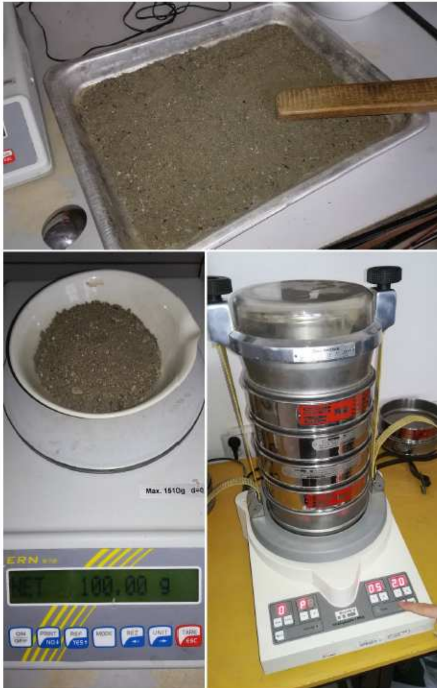
Obrázek 31: Ukázka postupu při prosévací zkoušce (SEDECO – Report 2, 2019).
