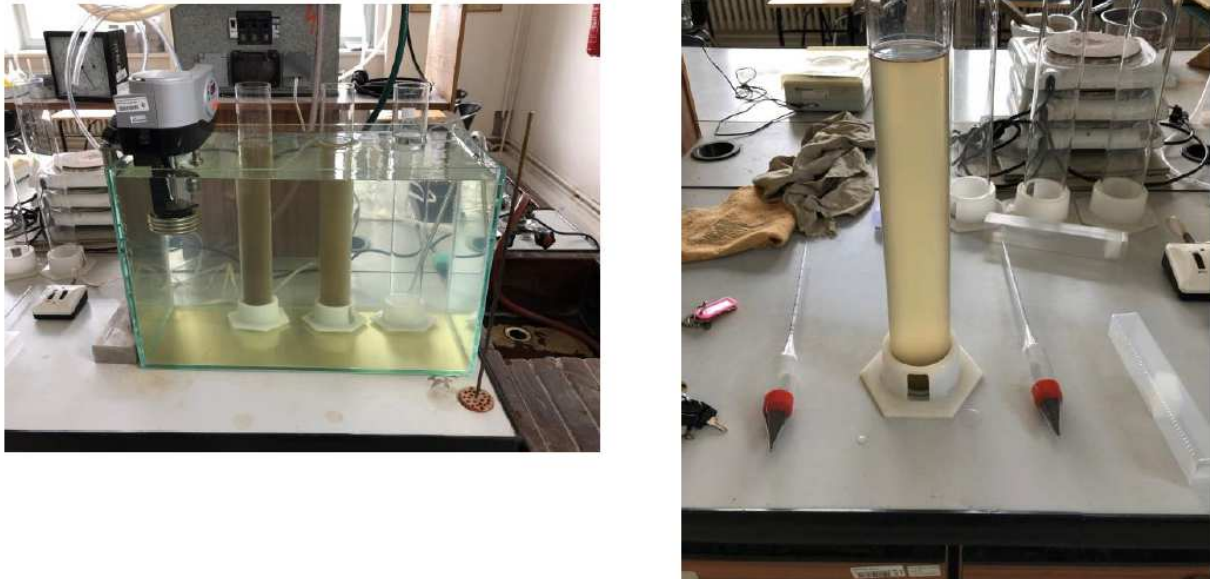
Obrázek 32: Měření jemnozrnných částic menších než 0,032 mm pomocí hustoměrné zkoušky vlevo a vpravo připravený odměrný válec s rozmíchaným materiálem v kapalině (SEDECO – Report 2, 2019).
