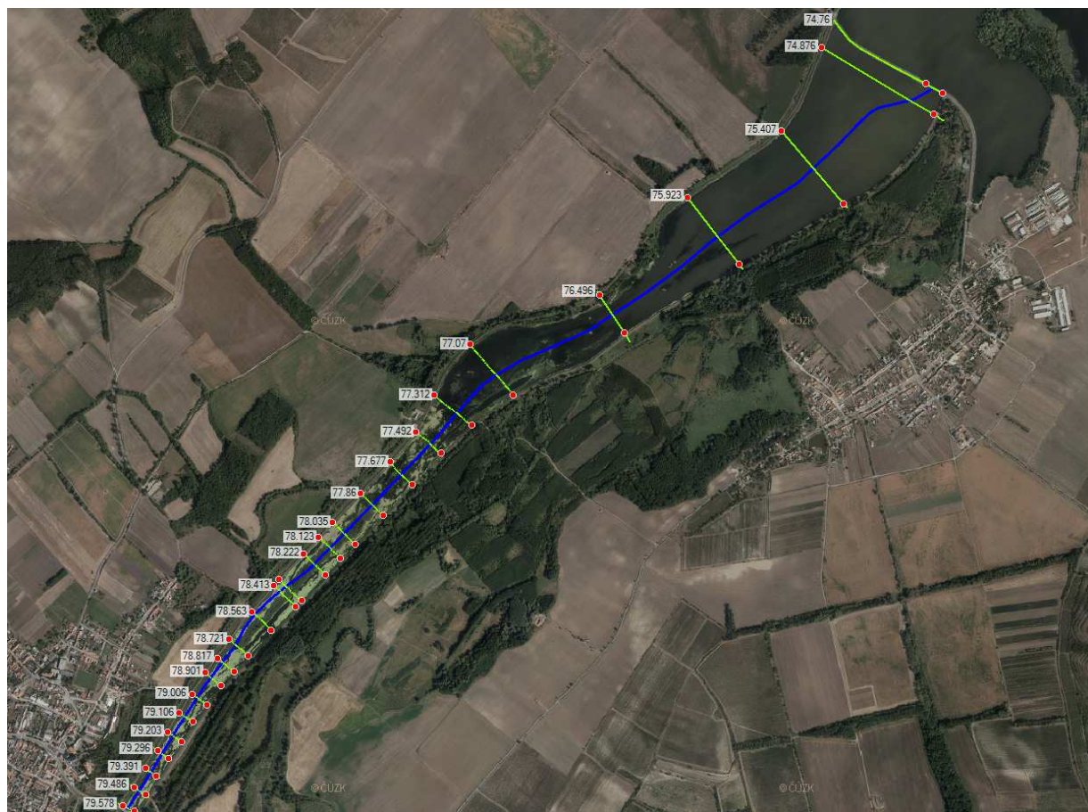
Obrázek 35: Ortofoto mapa s vynesnými příčnými profily z geodetického zaměření a s příčnými profily nádrže, určených z digitálního modelu terénu.
