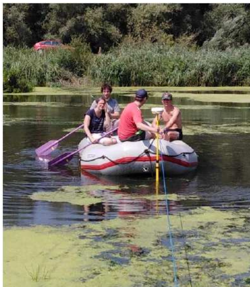
Obrázek 23: Proces měření příčného profilu toku Dyje (SEDECO – Report 1, 2019)
