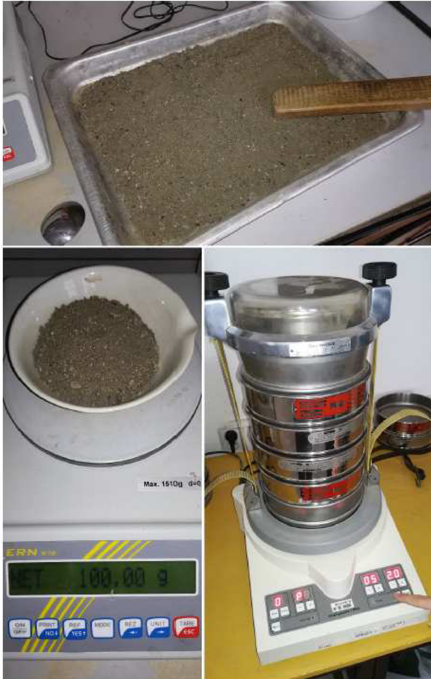
Obrázek 31: Ukázka postupu při prosévací zkoušce (SEDECO – Report 2, 2019).
